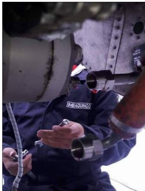
Figura 31 Tuberías Hidráulicas desconectadas
