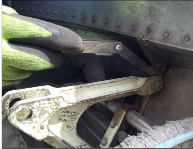
Figura 40 Inspección enlace superior
