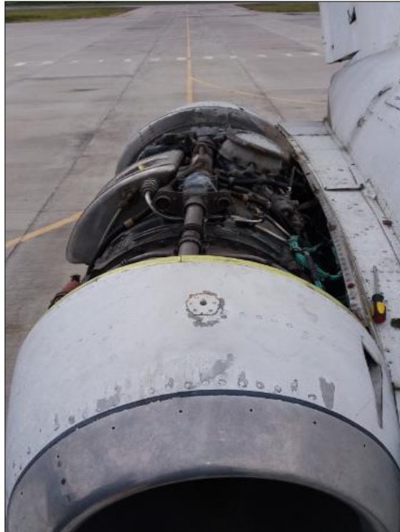
Figura 29 Motor sin cubiertas
