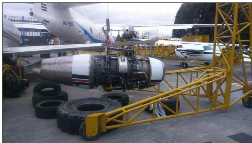
Figura 43 Elevación del motor para el montaje
