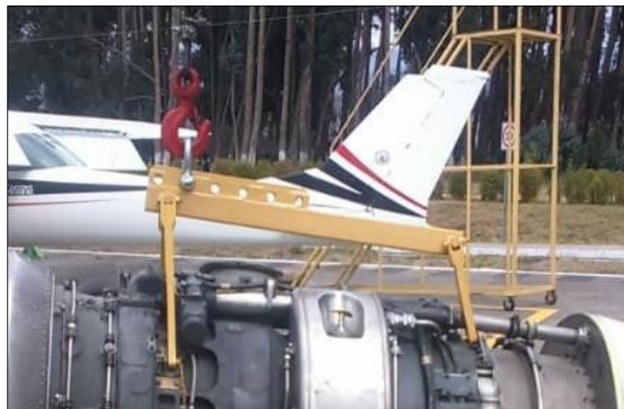
Figura 33 Colocación eslinga al motor
