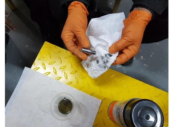
Desmontar de los motores ROLLS ROYCE VIPER 522 del avión escuela Hawker Siddeley 125-400 e inspeccionar los montantes y determinar el estado real de dichos componentes
