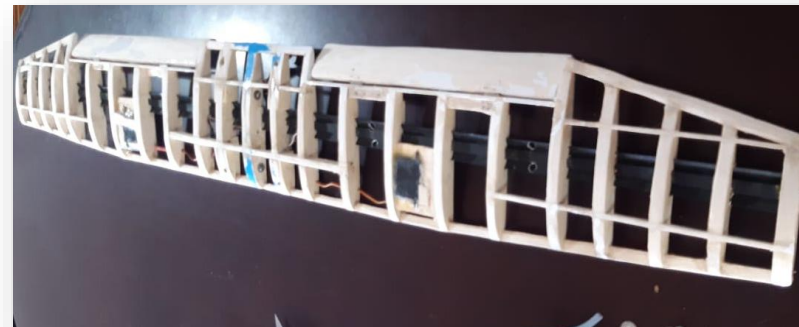
Reparación de costillas
