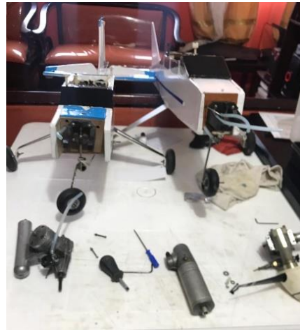
Desmontaje de motores
