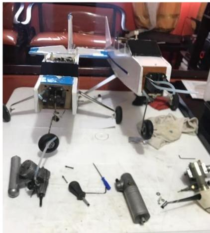
Nota. En la imagen se puede observar el desmontaje de los motores de cada uno de los modelos con la finalidad de realizar el mantenimiento respectivo, posterior a la inspección visual de las aeronaves.
