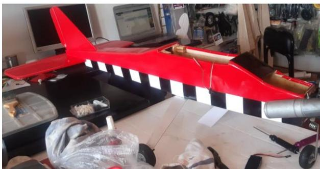
Nota. En la imagen se puede observar el recubrimiento completo del fuselaje con material monokote.
