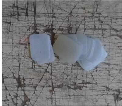
Nota. La imagen representa las bisagras de material nylon que fueron instaladas en las superficies móviles de la aeronave.
