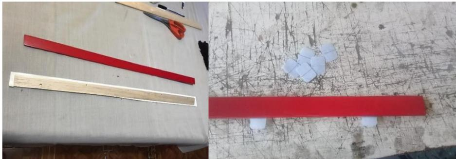
Nota. La imagen demuestra tanto el recubrimiento de las superficies móviles con papel monokote y la instalación de bisagras en las mismas.
