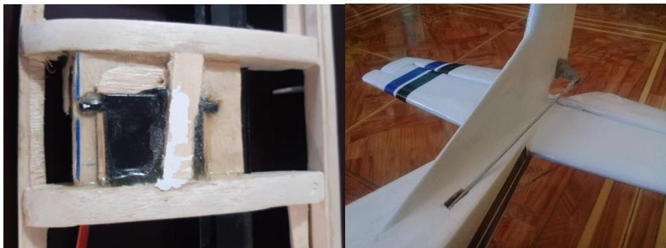
Nota. En la figura se observa la ubicación inadecuada de los servos, dentro de la estructura del ala y el cambio de control horn de varillas.
