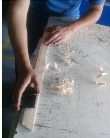
Nota. En la figura se aprecia el uso de la garlopa para la correcta nivelación de las superficies, se debe tener cuidado con este tipo de herramientas manuales.
