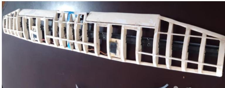
Nota. En la imagen se observa el estado deteriorado del ala, esta cuenta con una viga de aluminio, lo que impedía el acceso a la zona inferior del ala.
