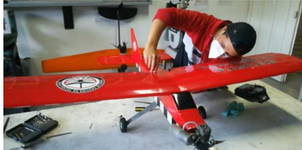
Nota. En la imagen se aprecia el ajuste del ala con el fuselaje.
