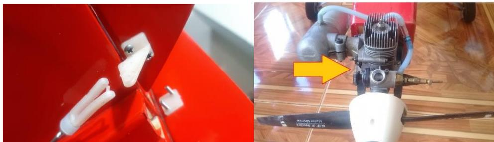
Nota. La imagen hace referencia al cambio de control horn en estabilizadores y cambio de seguros en la varilla pushrod del control del carburador.
