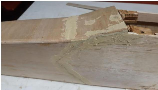
Nota. La imagen representa la masilla totalmente seca aplicada en la zona delantera de la cabina del fuselaje, para su posteriormente realizar el alisado respectivo.
