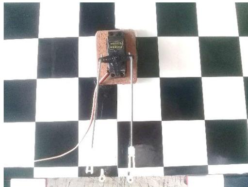
Nota. En esta imagen se puede observar el servo instalado en la superficie inferior del ala con sus respectivas varillas, su juego de control horn y sus cables de conexión para el receptor.
