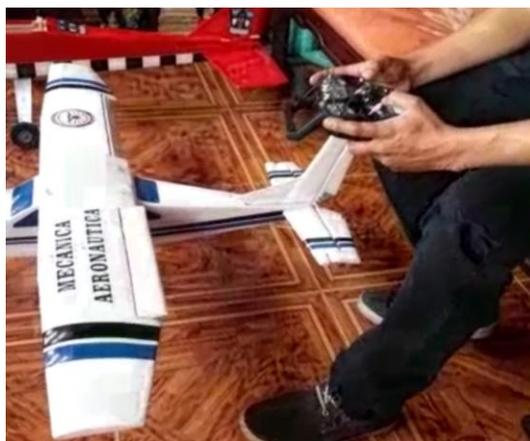
Nota. La imagen demuestra el proceso de alineación de los controles de vuelo, operando los mismos con el radiocontrol enlazado a su receptor.
