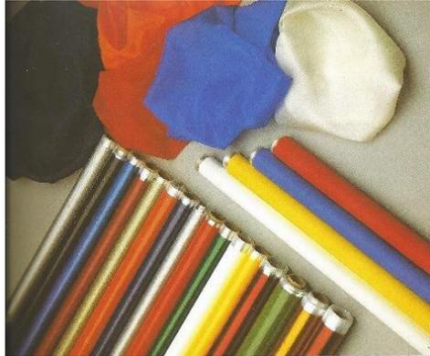
Nota. En la imagen se observa materiales como vinil y monokote para el recubrimiento de las superficies de las aeronaves. Tomado de (Aeromodelismo - Fácil, 2014)
