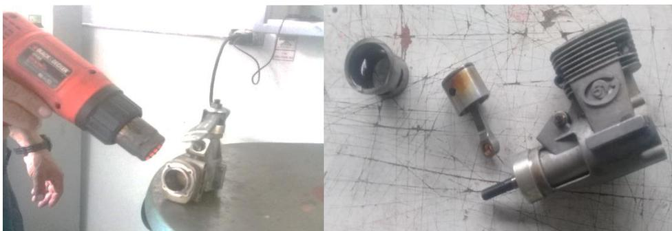
Nota. La imagen muestra el sometimiento del motor a altas temperaturas y la remoción de sus partes una vez que el calor ayudó a sus partes a tener movilidad.
