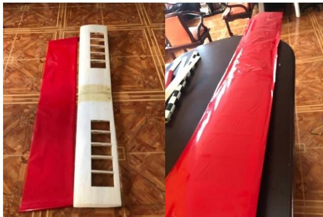
Nota. En la imagen se visualiza el papel monokote antes de ser adherido a la superficie alar y después de haber sido instalado.
