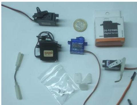
Nota. Los componentes de la figura son servos de distintas marcas que cumplen la misma función, ejercer el movimiento mecánico necesario para distintos componentes que requieran de fuerza mínima. Tomado de (Morato, s.f.)
