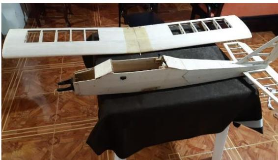
Nota. La imagen representa notablemente el desprendimiento de la piel que cubría la estructura principal y su ala, se debe retirar cuidadosamente para evitar residuos del material en la estructura.
