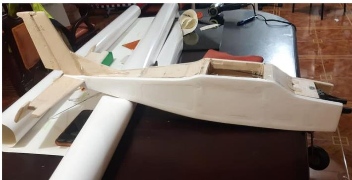
Nota. En la imagen se aprecia el resultado de la corrección de las fallas y su alisado.
