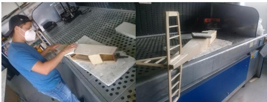
Nota. En la figura se puede apreciar que el alisado del fuselaje se realizó sobre un extractor de polvo, para evitar la inhalación del mismo.
