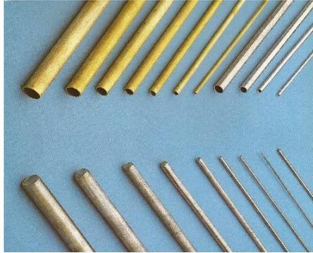
Nota. La imagen representa aleaciones de aluminio, acero y plomo, los cuales son usados en construcción de aeromodelos de grandes dimensiones. Tomado de (Aeromodelismo - Fácil, 2014)
