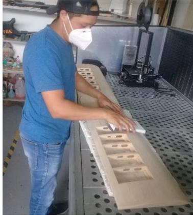
Nota. La imagen demuestra el alisado minucioso que se aplica a este tipo de superficies, debido a la sensibilidad de la madera balsa y de sus costillas recién instaladas.
