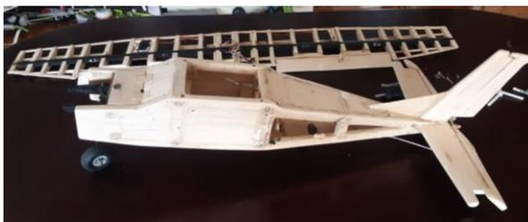
Nota. En la imagen se puede observar el decapado del recubrimiento de la estructura total de la aeronave.
