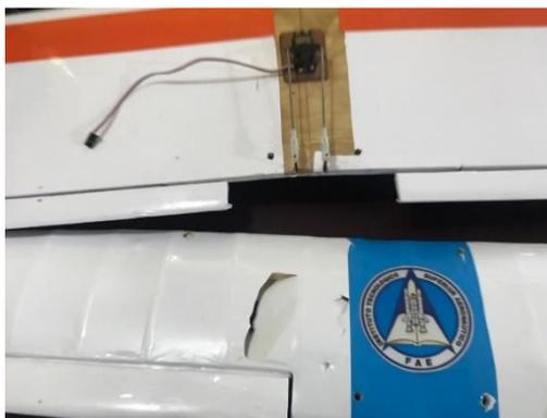
Nota. En la imagen se puede apreciar que al desmontar las alas, el deterioro es notable, los recubrimientos se encuentran rotos y mal conservados.
