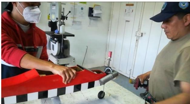
Nota. La imagen demuestra la prueba de encendido que se realizó al motor previo a la prueba de vuelo.
