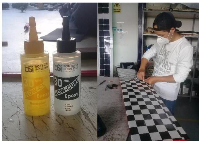
Nota. La imagen representa el pegamento epóxico empleado y la instalación de los alerones en la superficie alar.
