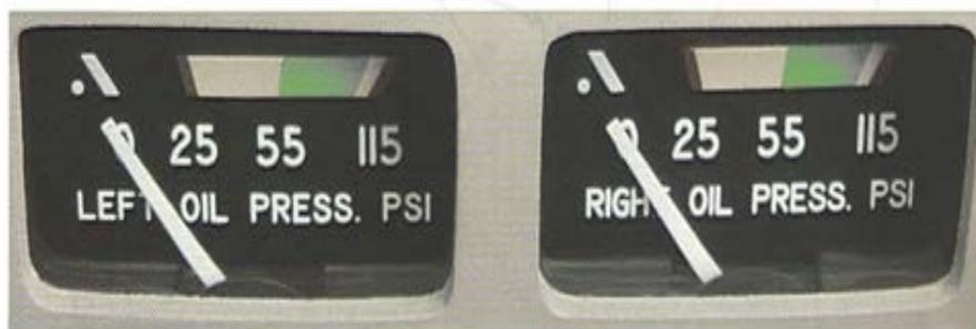
Nota: La figura representa al instrumento encargado de medir la presión del aceite en el funcionamiento del motor. Tomado de (Administration, 1971).
