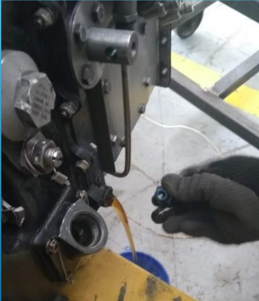
Drenaje del aceite utilizado
