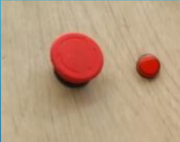
Botón de parada de emergencia y luz indicadora
