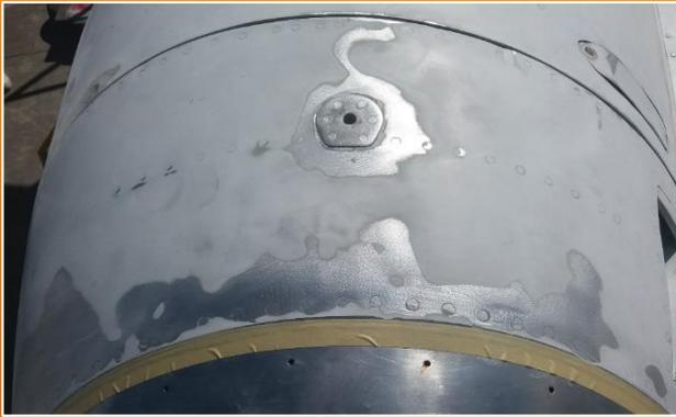
**EXTRACCIÓN DEL ÁREA CORROÍDA Y ELIMINACIÓN DE LA PINTURA**
