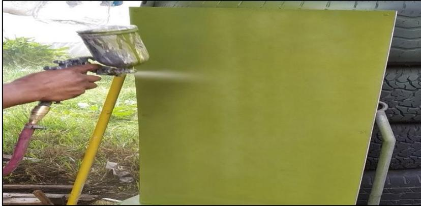
**Figura 36.** Capa de protección del panel.
