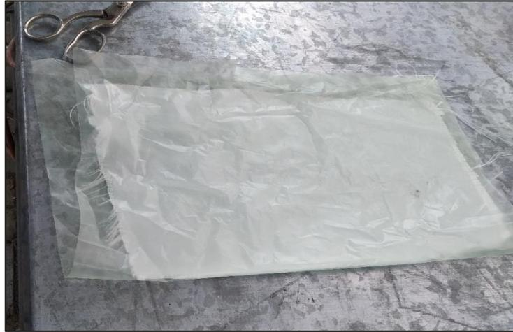
**Figura 19.** Fibra y Baggin film para el prepeg.
