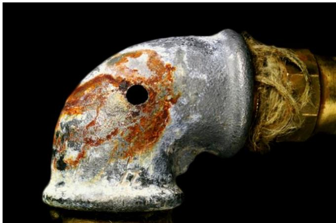
*Nota.* Esta imagen ilustra la corrosión causada por picadura en las cañerías, tomado de (Laminas y acero, 2015)
