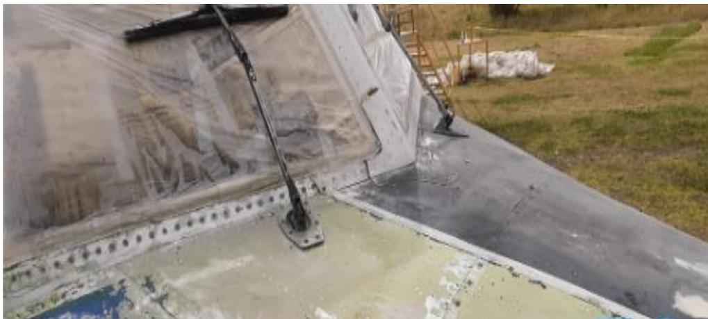
*Nota:* se realiza un nuevo enmascaramiento de varias secciones de la aeronave para posterior realizar la aplicación de pintura.
