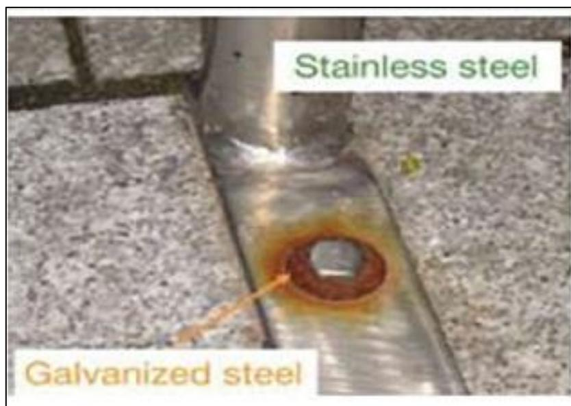
*Nota.* Esta imagen ilustra la corrosión galvánica que afecta a las arandelas y pernos. (F27-500, 2010).
