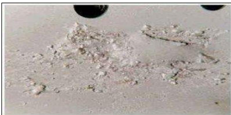
*Nota.* En la imagen se ilustra cómo afecta la corrosión por exfoliación en una estructura.
