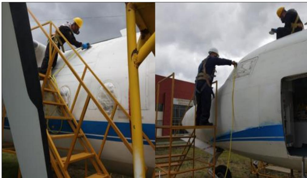
*Nota:* en esta figura podemos observar el trabajo que se ejecuta al momento de realizar el lijado mecánico.
