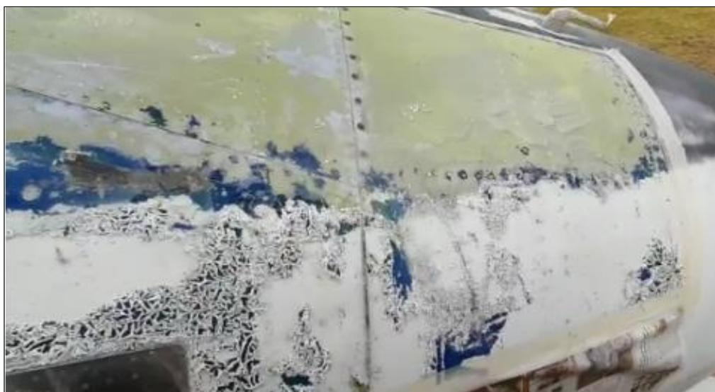
*Nota:* Se puede observar la actuación que tiene el removedor con la pintura en el fuselaje.
