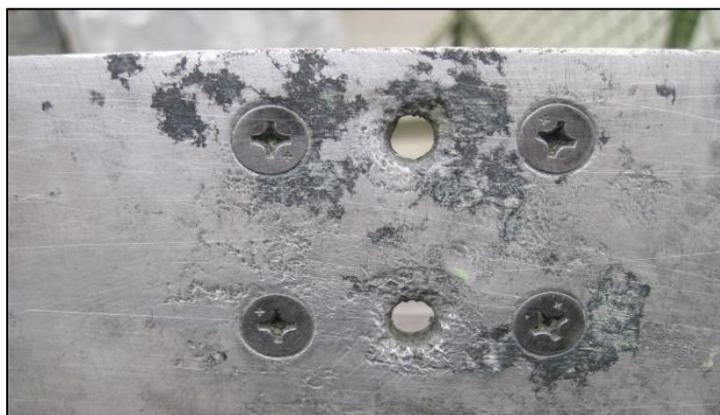
*Nota.* Esta imagen ilustra la corrosión causada por los factores atmosféricos. Tomada de (F27-500, 2010)
