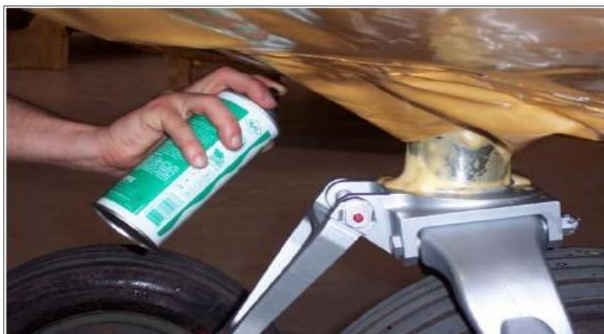
*Nota.* La imagen ilustra la aplicación de una sustancia anticorrosiva en tren de aterrizaje.
