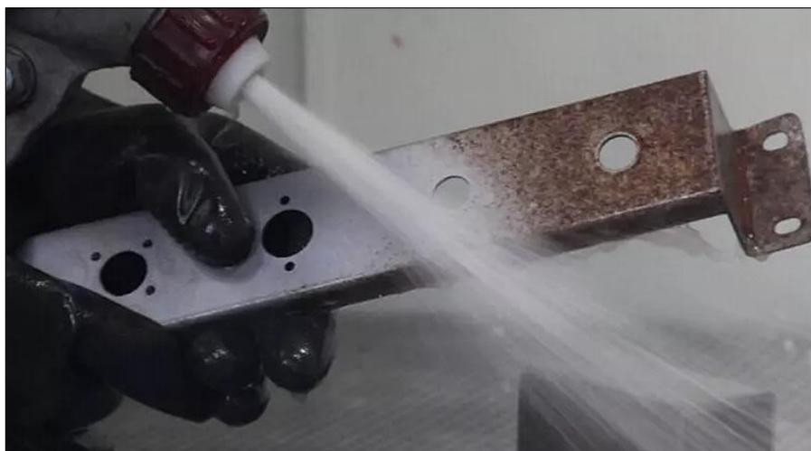
*Nota.* La imagen ilustra cómo se lleva a cabo la limpieza de la corrosión en un componente, tomado de (S.A, 2014).
