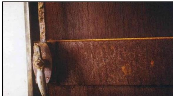
*Nota.* Esta imagen ilustra la corrosión causada por hendidura en superficies, tomado de (Laminas y acero, 2015)
