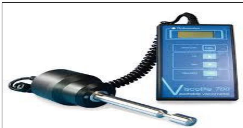
*Nota.* En la imagen se ilustra un instrumento utilizado para medir la viscosidad de la pintura, tomado de (Pce-instruments., s.f.)
