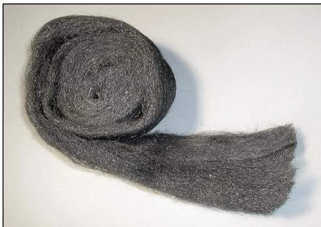
*Nota.* La imagen ilustra uno de los materiales que se utiliza para la limpieza de la corrosión antes de la pintura, tomada de (Demos.i303, 2012).
