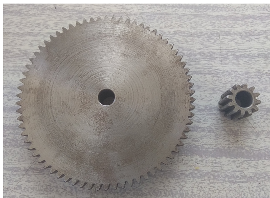
Figura 28 Engranajes fabricados a medida
