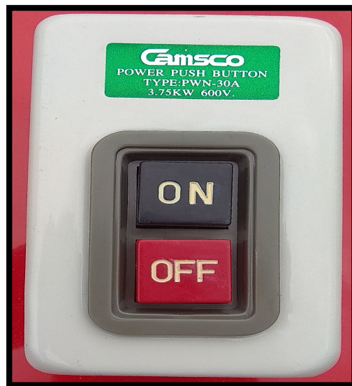
Figura 34 Interruptor del preservador
