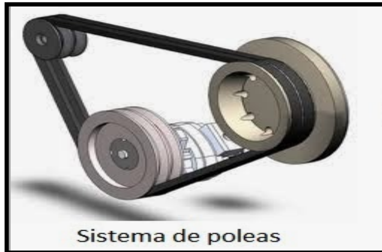
Figura 17 Transmisión por correa y poleas
