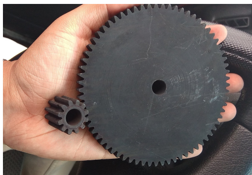
Figura 29 Tratamiento de Nitruración aplicado a los engranajes
