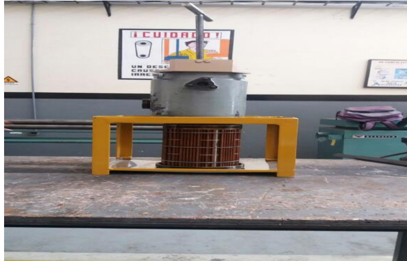
Figura 33 Remoción de la matriz del oil cooler.
