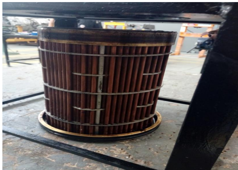
Figura 34 Remoción de la matriz del oil cooler.
