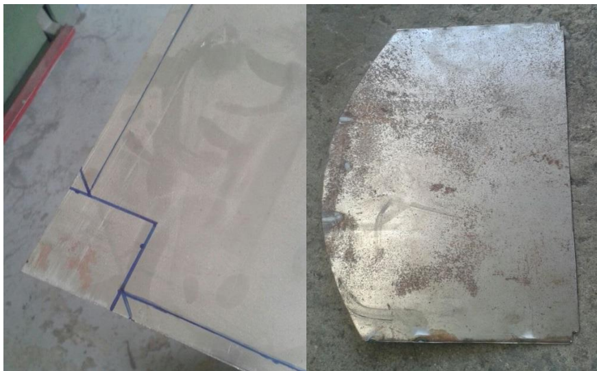
Figura 51 Medición, trazado y corte de la plancha de tol
