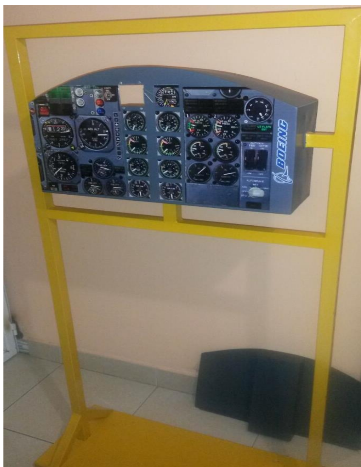
Figura 76 Sistema de comprobación de EPR terminado
