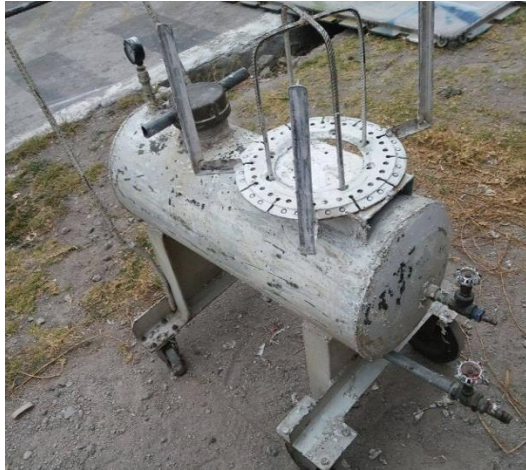
Figura 34 Primera capa de pintura removida
