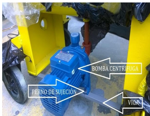
Figura 51 Sujeción de la bomba centrífuga
