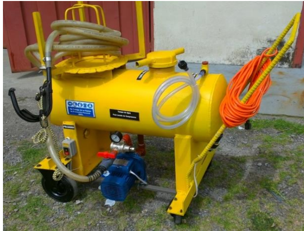
Figura 59 Tanque de agua para lavado de compresores
