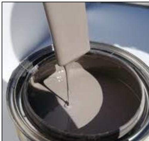
Figura 39 Preparación de la pintura FONDOLAC
