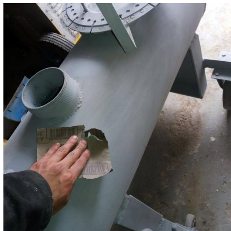
Figura 41 Lijado de la pintura
