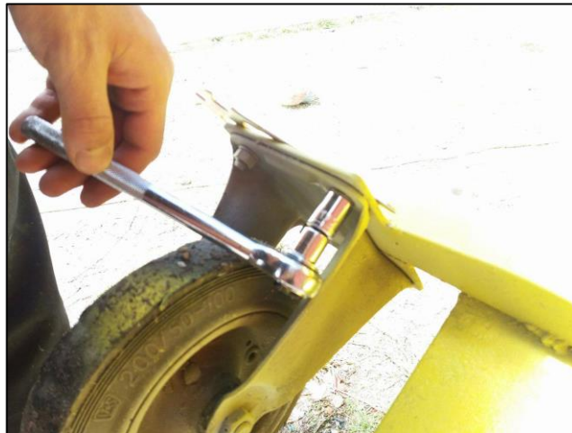
Figura 47 Desmontaje de ruedas industriales
