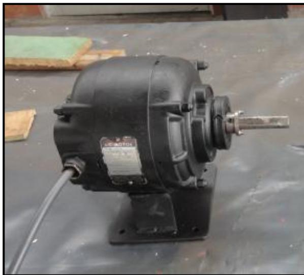
**Figura 32 Motor eléctrico trifásico (220VAC); 1720 RPM**
