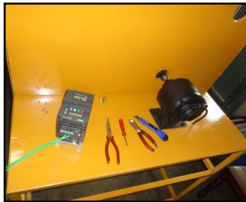
**Figura 34 Fijación del motor en el soporte**
