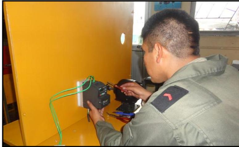
**Figura 37 Sujeción del variador SINAMICS V20**
