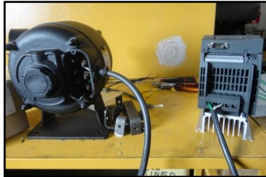
**Figura 39 Cable sucre para conexión del motor hacia el variador de frecuencia SINAMICS V20**
