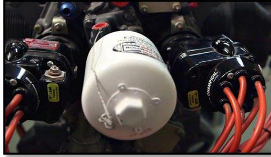
**Figura 16 Arneses y Magnetos Instalados en el Motor**
