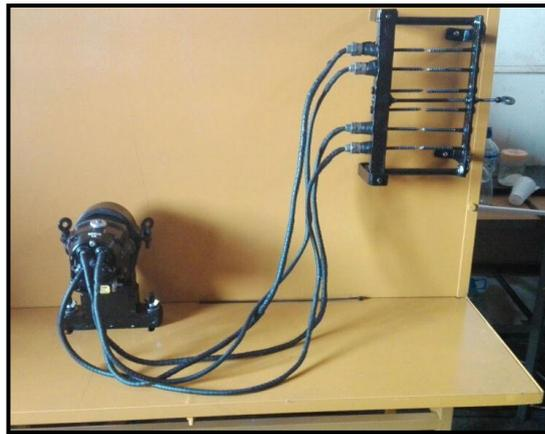
**Figura 42 Transmisor de energía, arneses y magneto**
