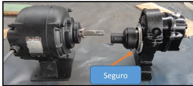
**Figura 48 Eje del motor que coincide con el eje del magneto**
