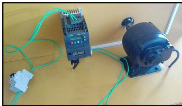
**Figura 40 Cable flexible #12 he interruptor de seguridad que va del variador de frecuencia hacia la toma de 220VAC**
