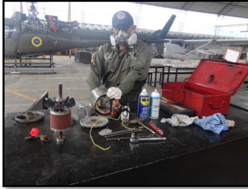
**Figura 33 Revisión y mantenimiento de motor eléctrico**
