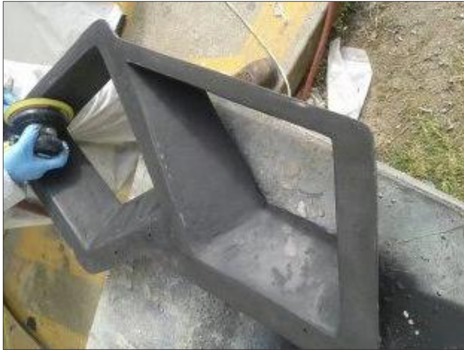
Figura 51 Acabados previos del FRAME ventanas
