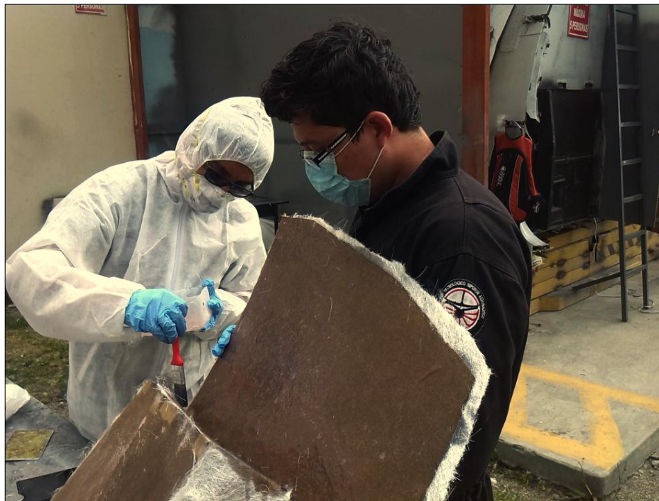
Figura 58 Colocación de fibra en SIDEWALL
