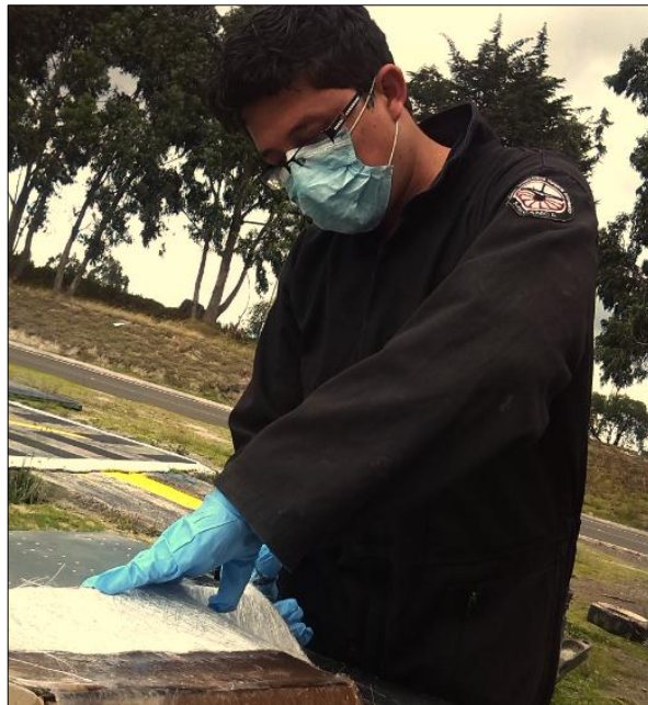
Figura 57 Moldeado de los SIDE WALL
