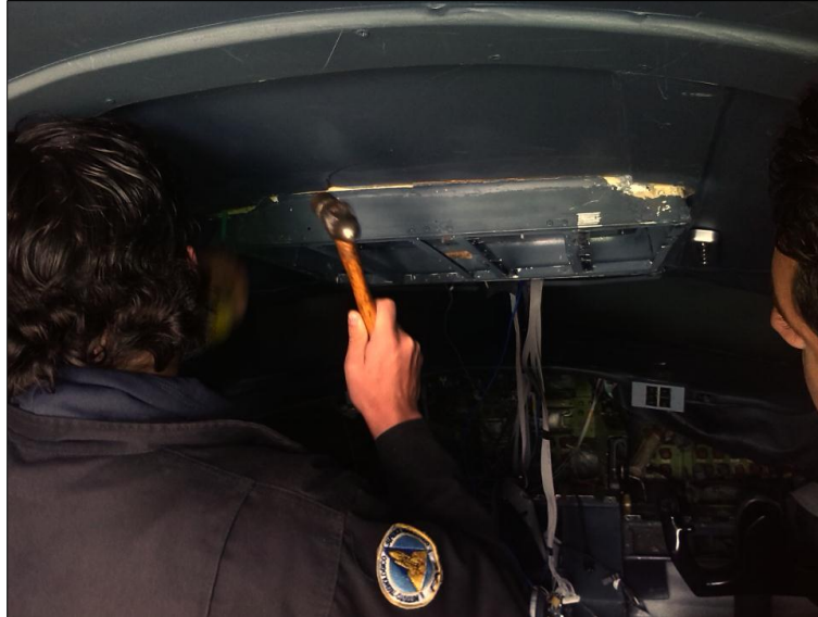
Figura 26 Desarme del marco OVERHEAD
