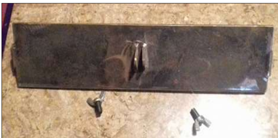
Figura 27 Placa regulable vista frontal con pernos de sujeción
