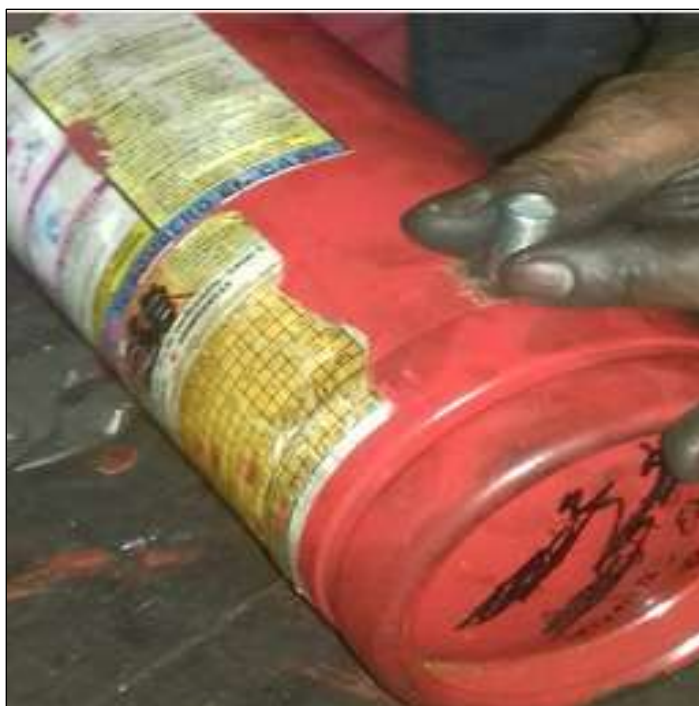
Figura 36 Preparando el orificio para soldar el acople
