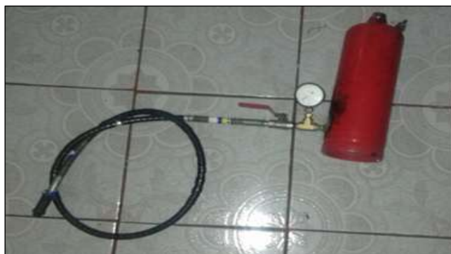
Figura 41 Reservorio con sus conexiones para el fluido hidráulico.
