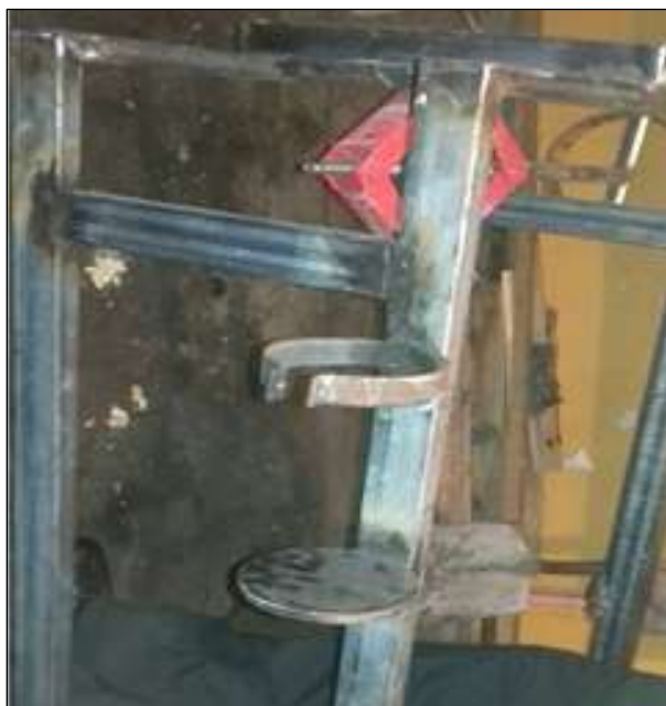
Figura 25 Soporte del reservorio
