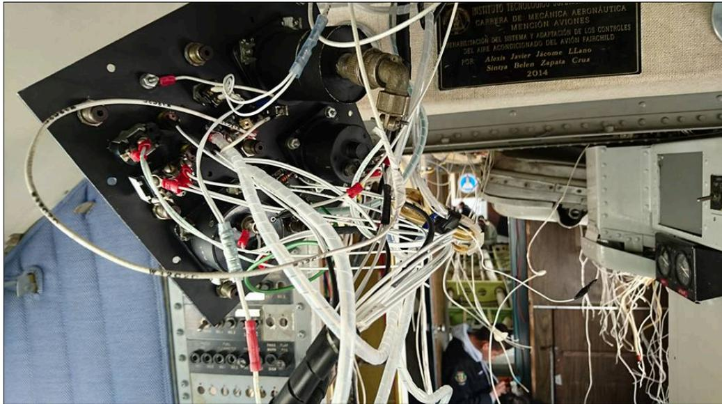
**Figura 24 Enrutamiento hacia el panel de control**
