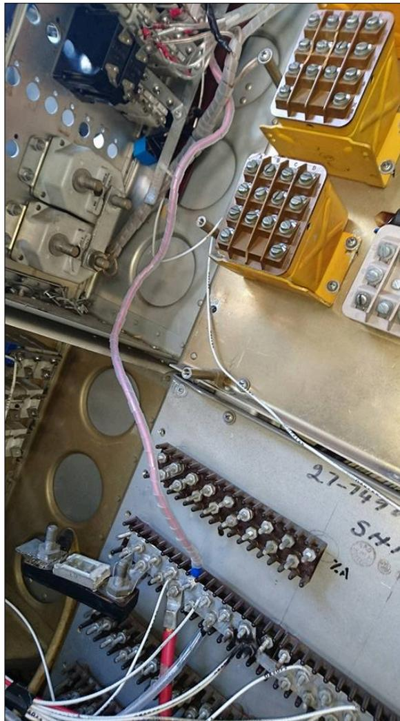
Figura 23 Enrutamiento desde la barra de 28v hacia el circuitbreaker
