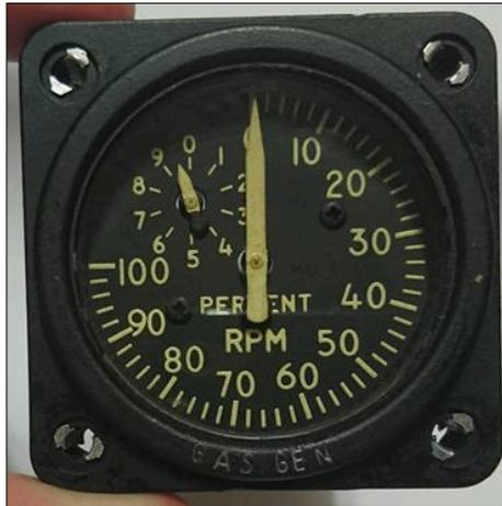
**Figura 10 Indicador de RPM**
