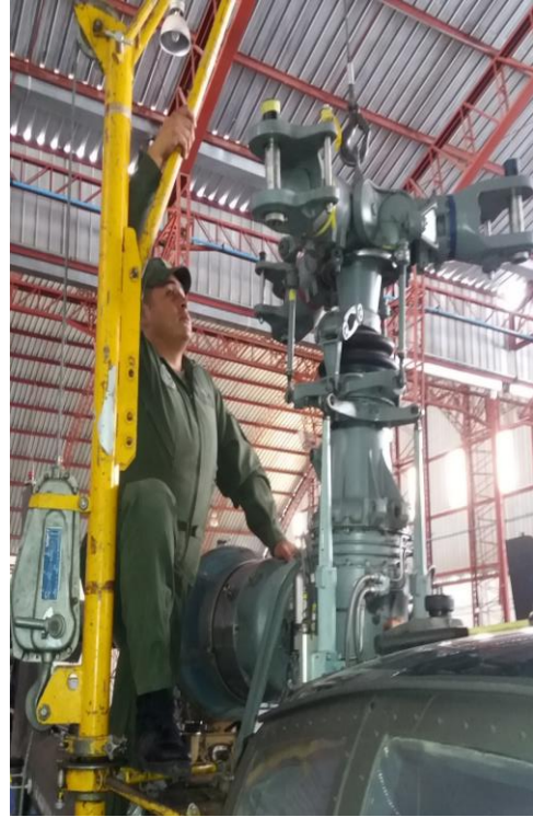
Figura 26 Colocación del tecele
