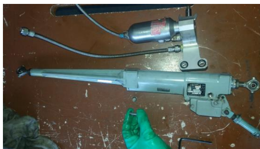
Figura 48 Desmontaje y cambios de sellos en los servos principales
