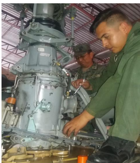
Figura 52 Montaje de la BTP en el helicóptero
