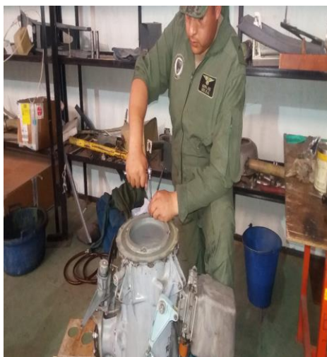
Figura 45 Montaje de la primera etapa de satélites de la BTP
