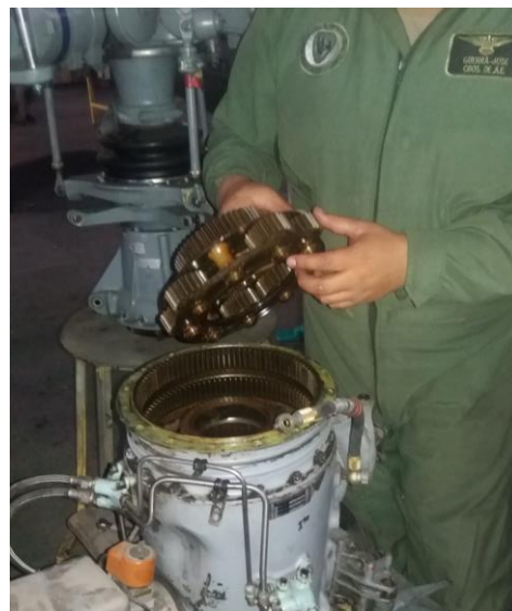
Figura 33 Desmontaje de los satélites
