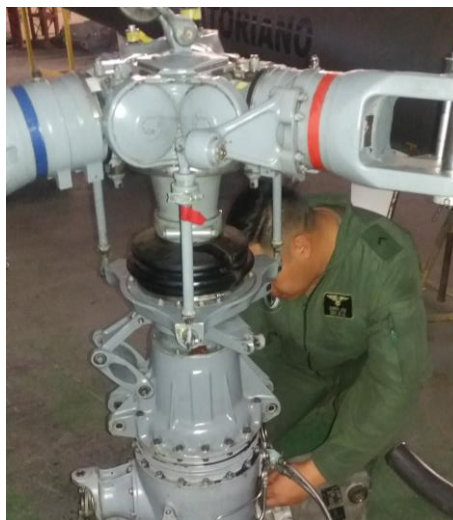
Figura 50 Montaje de la cabeza del rotor principal a la BTP
