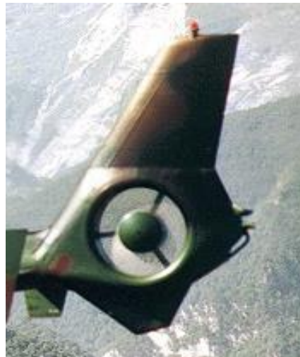
Figura 3 Rotor con Fenestrón
