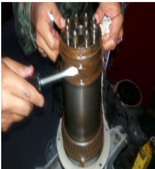
Figura 42 Desmontaje del eje de la cabeza del rotor principal
