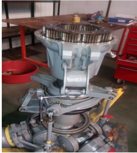
Figura 44 Montaje de la segunda etapa de satélite de la BTP
