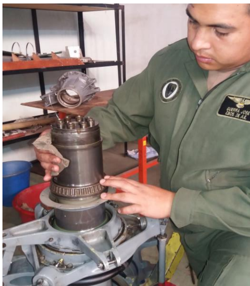
Figura 43 Limpieza y montaje del eje de la cabeza del rotor principal
