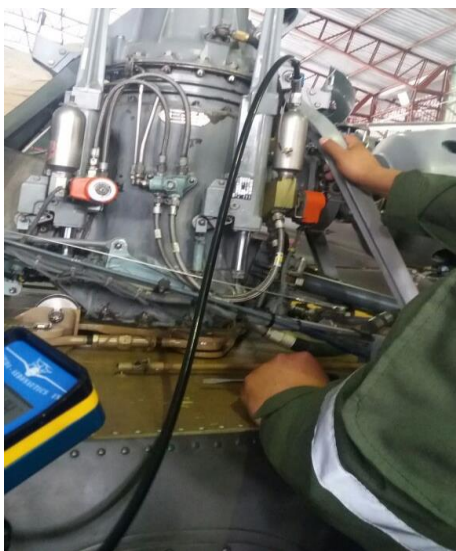
Figura 54 Llenado de nitrógeno en el acumulador
