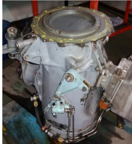
Figura 34 Desmontaje de la segunda etapa de satélite
