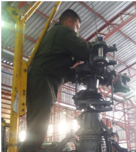
Figura 53 Desmontaje del tecele
