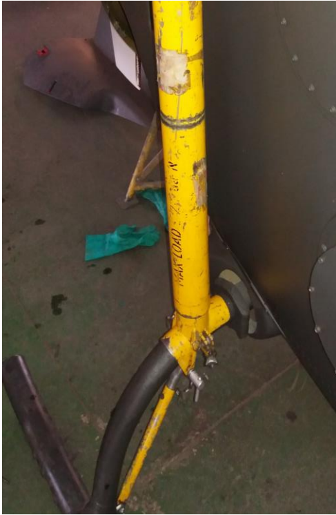
Figura 25 Colocación del tecele portátil
