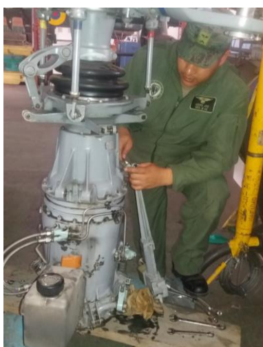
Figura 46 Desmontaje los servos principales
