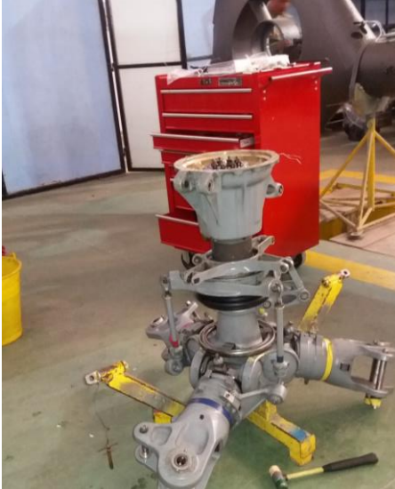
Figura 37 Cabeza del rotor principal Figura 38 Eje Cabeza de la BTP
