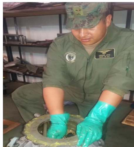
Figura 36 Limpieza interior BTP
