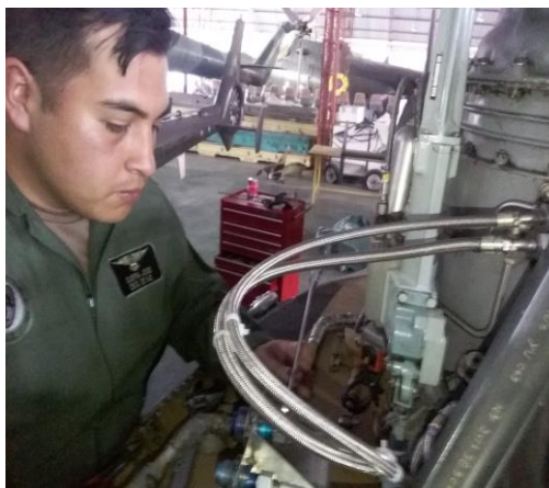
Figura 60 Verificación de fugas
