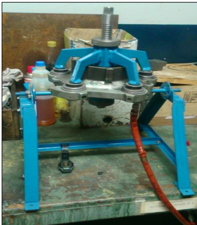
Figura 52 Sangrado de la unidad de frenos
