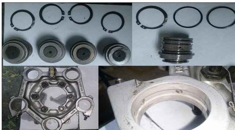
Figura 55 Desmontaje de los pistones
