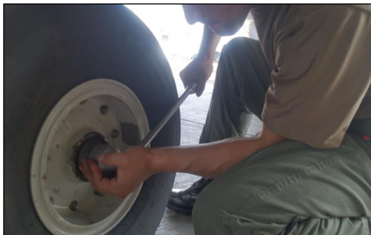
Figura 57 Montaje de la rueda principal
