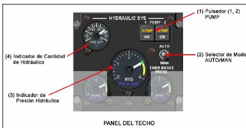
Figura 39 Modulo sistema hidráulico avión Casa CN-235
