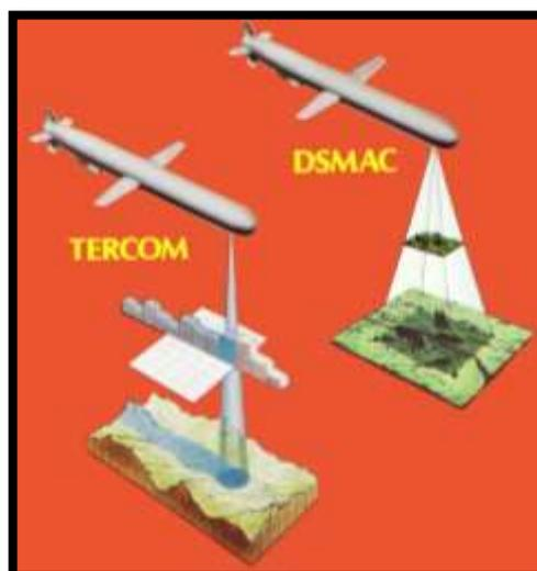
**Figura. 5** Sistema de navegación DSMAC
