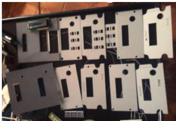
**Figura. 38** Paneles mecanizados listos para insertar electrónica.
