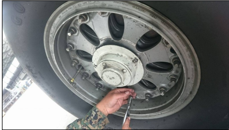
Figura 68: Colocación del alambre de frenado
