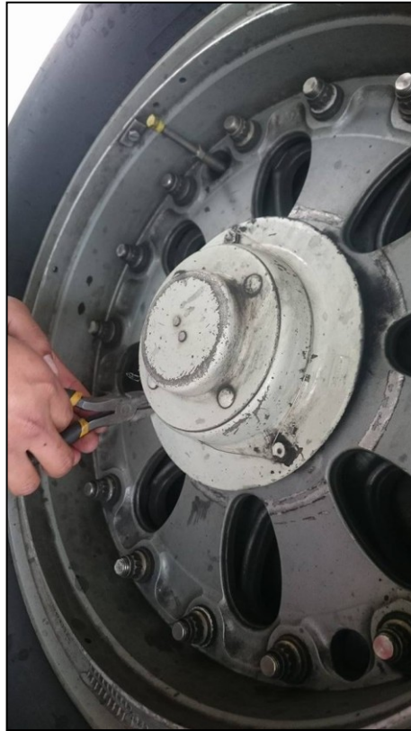
Figura 29: Remoción del alambre de frenado.
