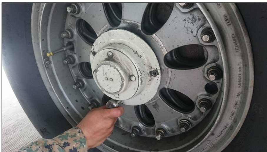
Figura 30: Remoción de pernos de la tapa de la tuerca del eje
