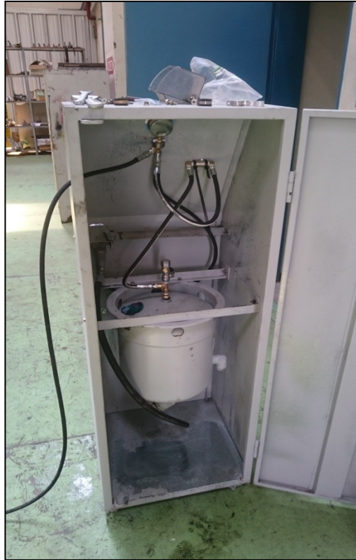
Figura 50: Circuito hidráulico en el suministro de Skydrol
