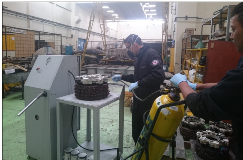
Figura 57: Sopleteada con nitrógeno de la parte externa del freno
