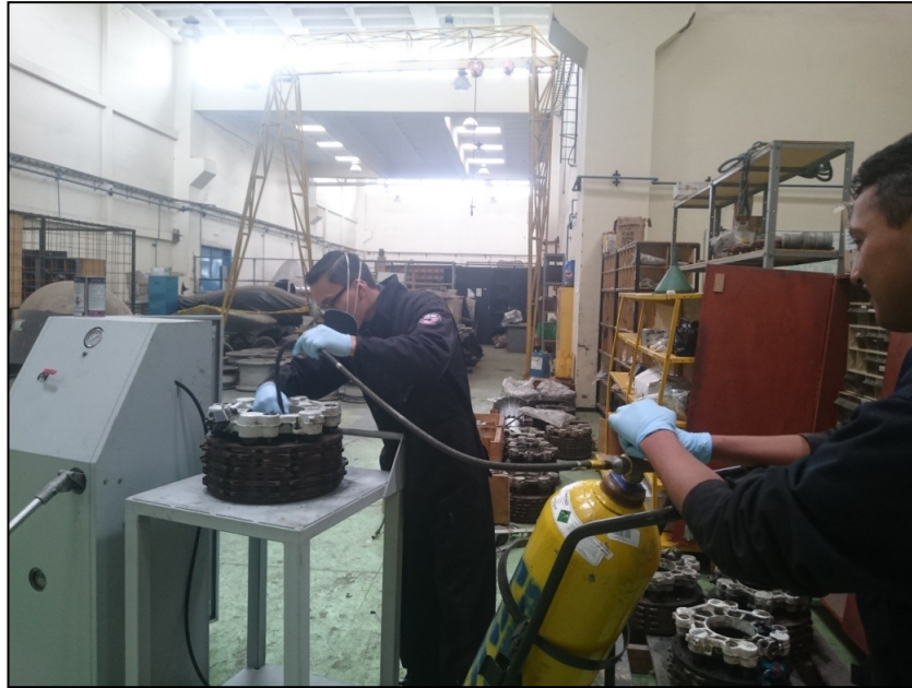
Figura 56: Sopleteada con nitrógeno de la parte interna del freno
