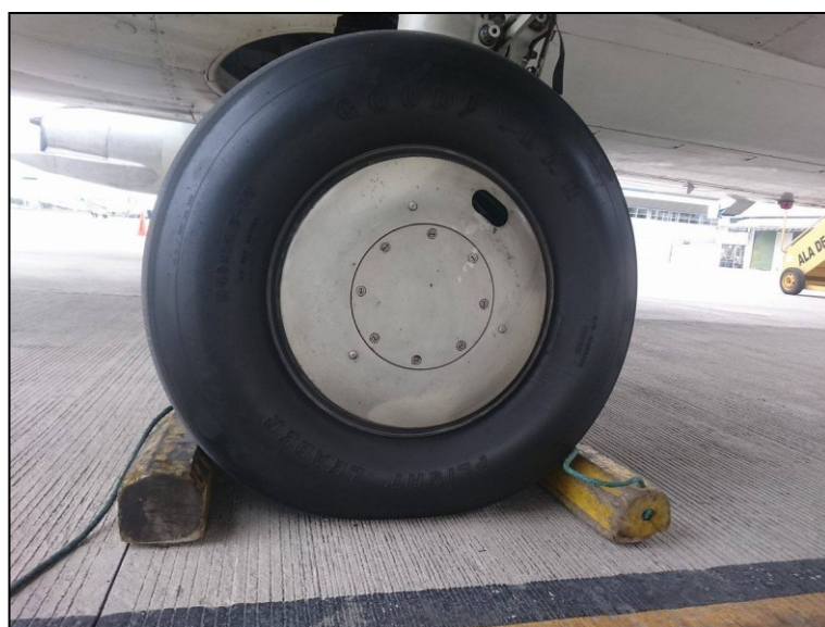
Figura 24: Colocación de tacos
