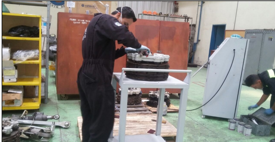
Figura 53: Limpieza del freno
