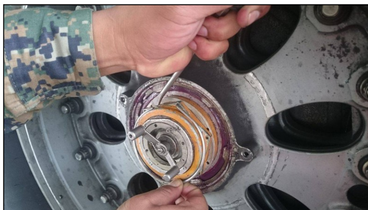
Figura 32: Remoción del retenedor de seguridad
