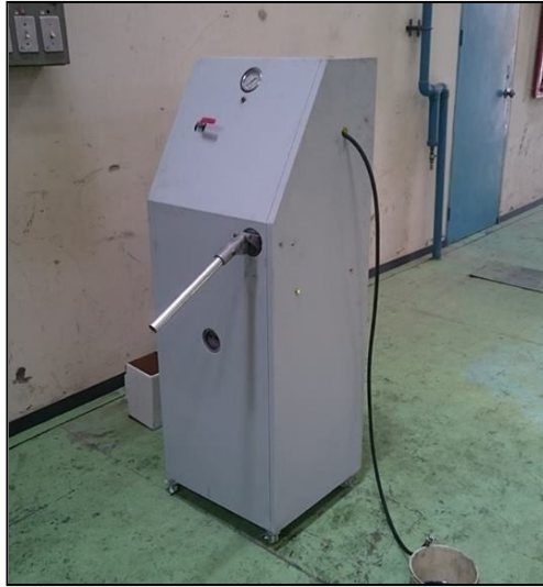
Figura 38: Estructura del Suministro de Skydrol
