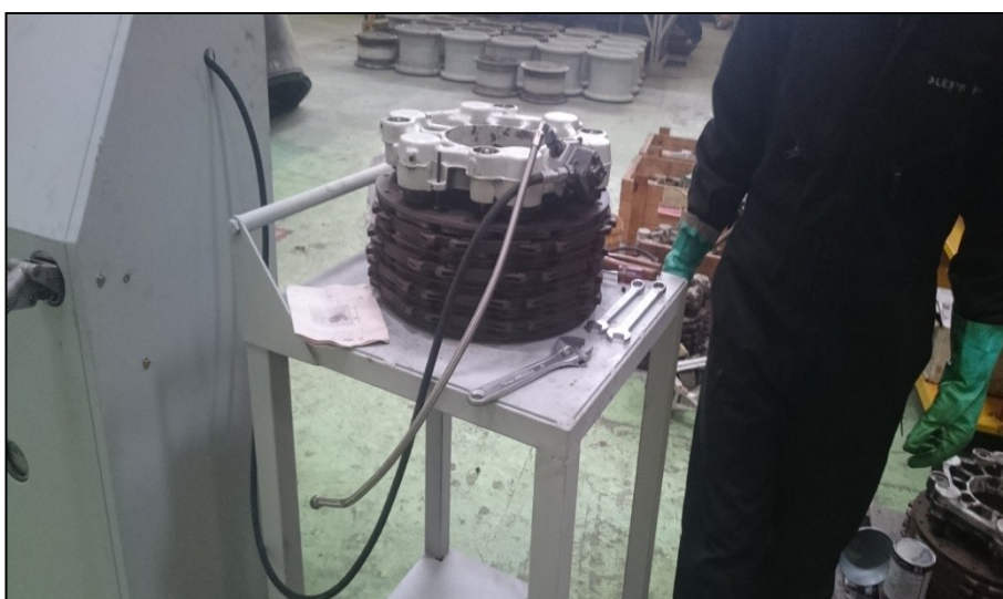
Figura 63: Cañería instalada en la válvula de sangrado
