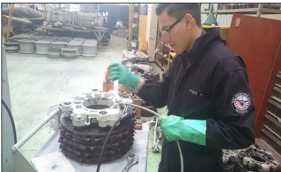
Figura 62: Conexión de la cañería a la válvula de sangrado
