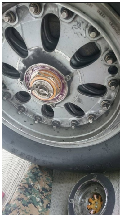
Figura 31: Tapa de la tuerca removida
