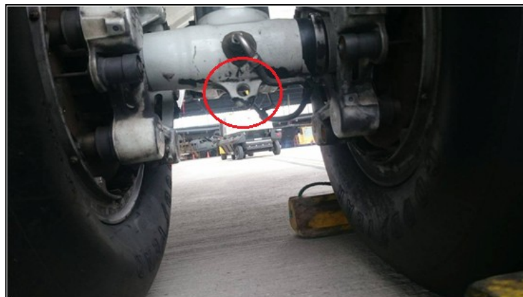
Figura 28: Punto de colocación de gato
