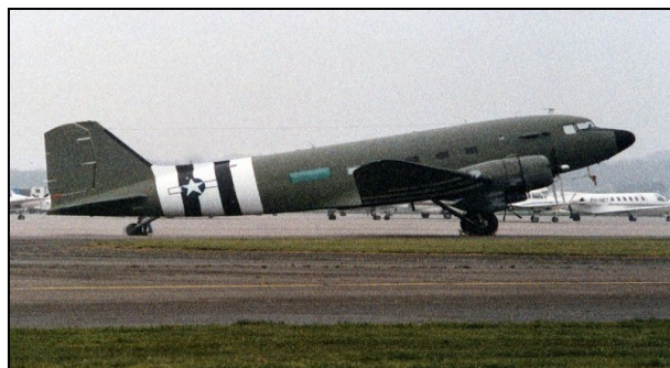
Figura 4: Tren convencional o Triciclo invertido (Douglas C-47)
