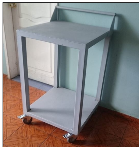
Figura 47: Estructura de soporte de freno ensamblada
