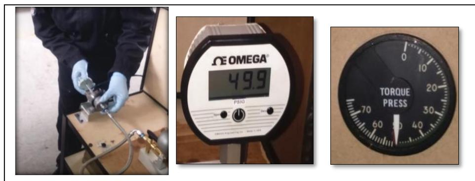
**Figura 52 Proceso de calibración del transmisor de torque**
