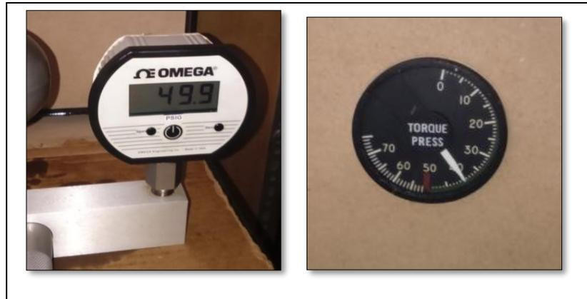
**Figura 51 Comprobación del transmisor de torque**
