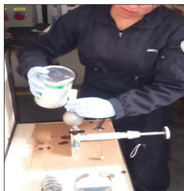
**Figura 44** Llenado de fluido en el comprobador
