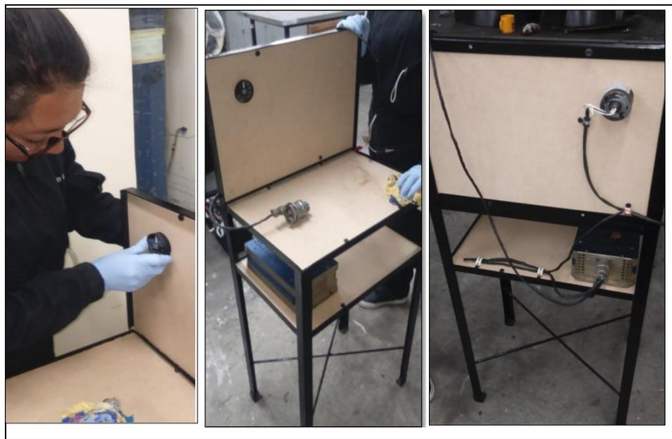
**Figura 37 Instalación del indicador de torque**
