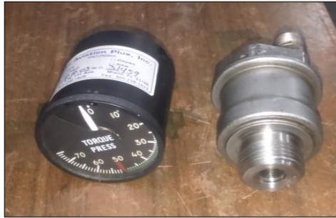
**Figura 40 Transmisor de torque e indicador de torque**
