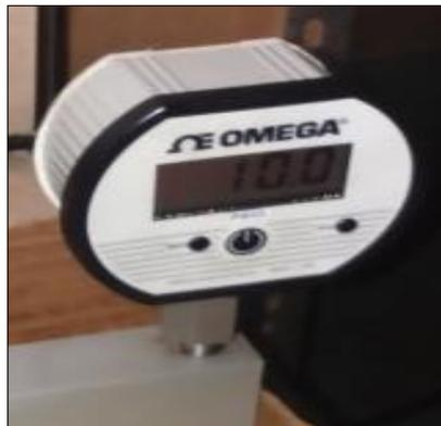
**Figura 31 Manómetro digital**
