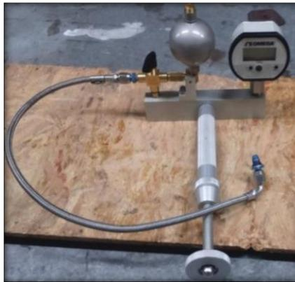
**Figura 32 Equipo comprobador de presión**
