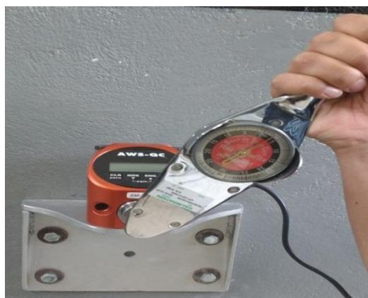
**Figura 103** Torquímetro de DIAL 30 FT-LB
