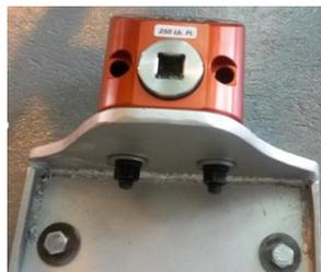
**Figura 70** Pernos de sujeción del equipo.
