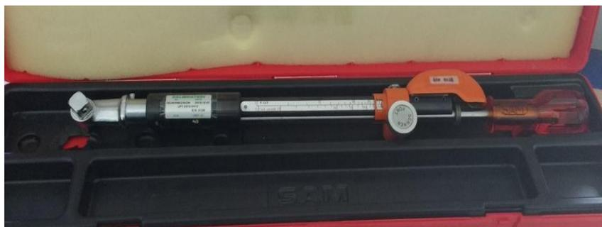
**Figura 102** Torquímetro de 83,33 FT-LB de la UGT-ESPE.
