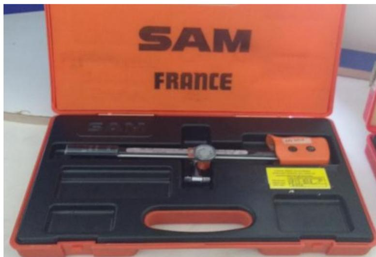
**Figura 101** Torquímetro de 125 FT-LB de la UGT-ESPE.
