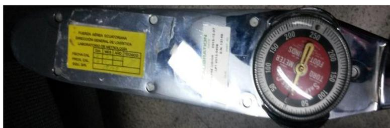
**Figura 83** Torquímetro.
