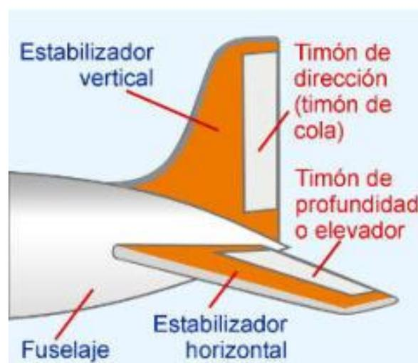
**Figura 9** Estabilizador Horizontal y Vertical del avión.
