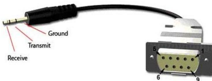
**Figura 99** Cable de transmisión y recepción.
