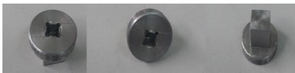
**Figura 81** Acople Hembra para Equipo AWS-QC.
