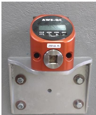
**Figura 69** Torquímetro Empotrado en la pared.
