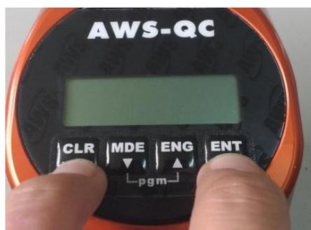
**Figura 94** Modo para Apagar equipo.
