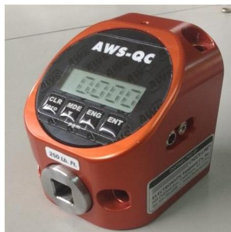
**Figura 63** Calibrador de torquímetros.
