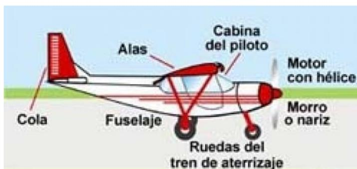
**Figura 2** Partes principales de la aeronave
