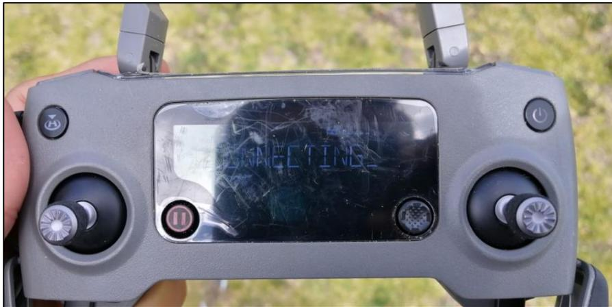
**Figura 42.** Palancas enroscadas en el control
