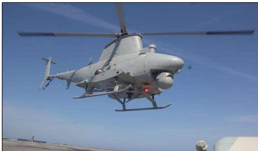
**Figura 13.** UAV con un rotor principal y uno de cola
