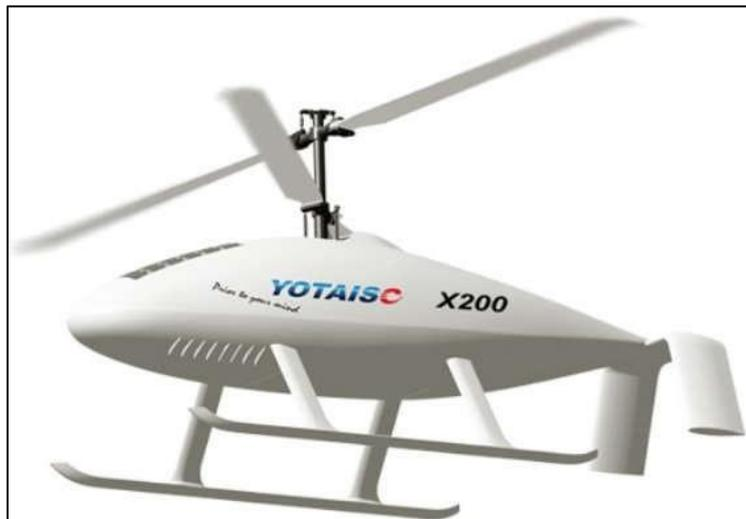
**Figura 15.** UAV de rotores coaxiales
