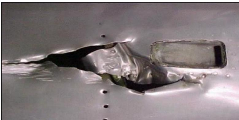
**Figura 8.** FOD en el fuselaje
