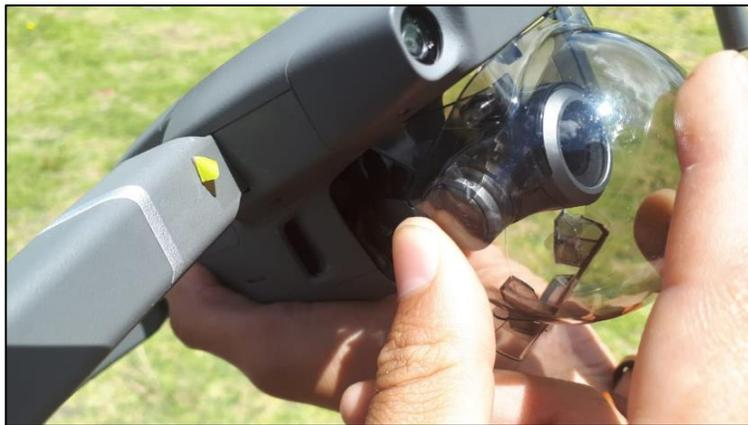
**Figura 40.** Retiro de protección cámara
