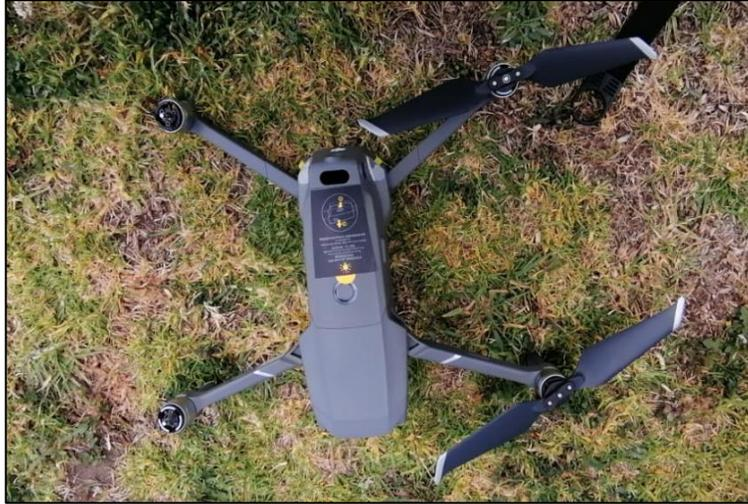
**Figura 39.** Colocación de las hélices
