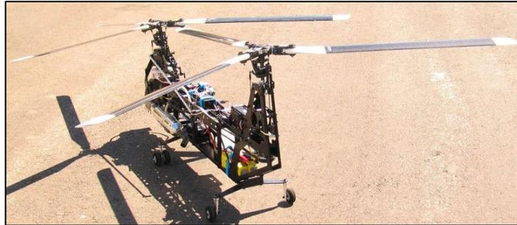
**Figura 16.** UAV en configuración tándem
