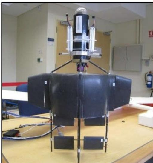
**Figura 14 .** UAV con un solo rotor
