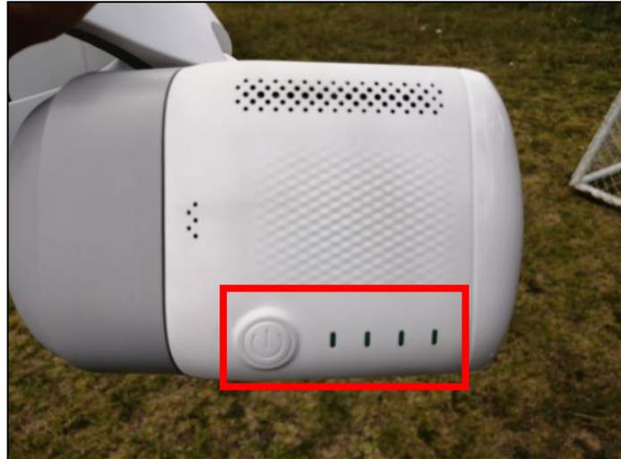
**Figura 45.** Encendido de las Goggles
