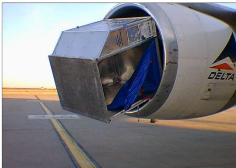
**Figura 5.** Daño en turbina por FOD
