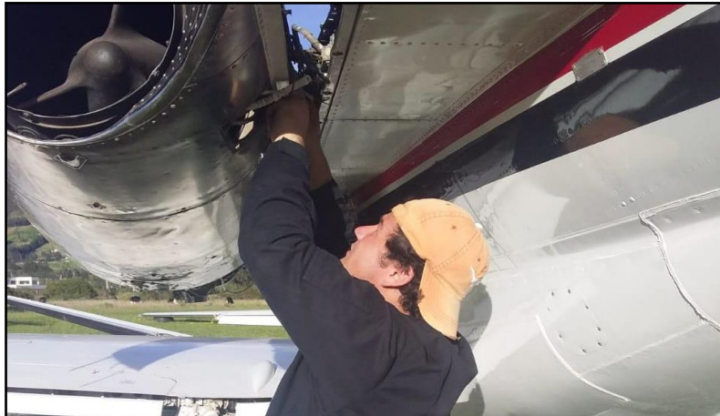
Figura 29. Conexión de cableado de la pared de fuego.
