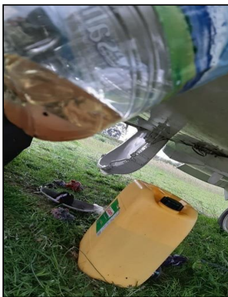
Figura 30. Drenado de combustible, con presencia de contaminación.
