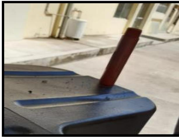
*Nota.* Se acopla la plomería en caliente con el calor producido del taladro y a presión sobre el enrosque
