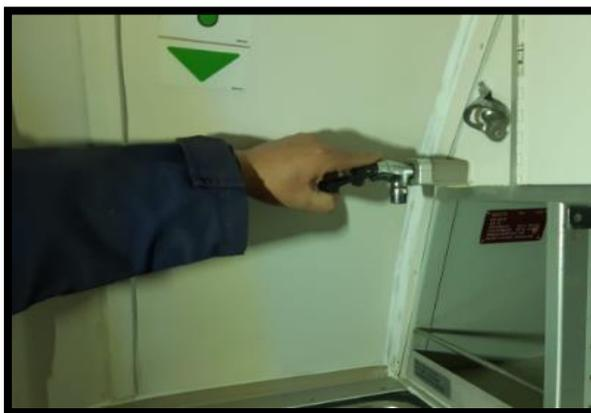
*Nota.* Para drenar el agua del sistema antes mantenga las llaves de la aeronave abiertas por lapso de 10 minutos
