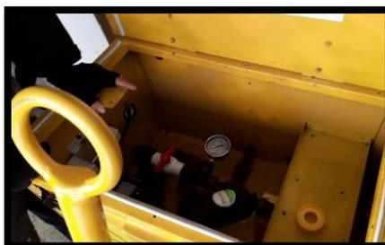
*Nota.* Cerrando la válvula de paso se evita el flujo a la manguera que puede derramar el agua
