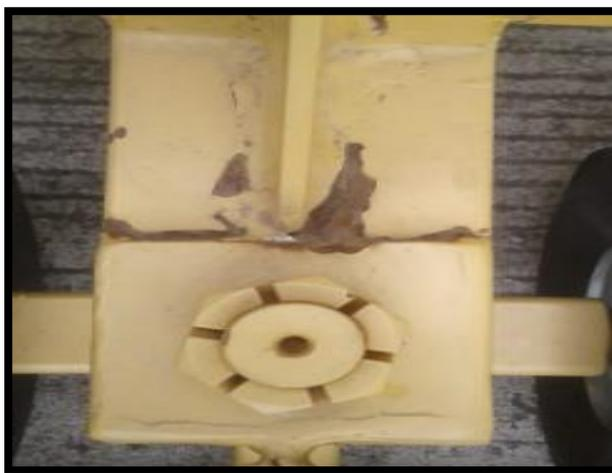
*Nota.* Muestras de corrosión en eje de dirección
