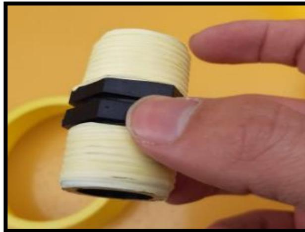
*Nota.* Conector con teflón acoplado
