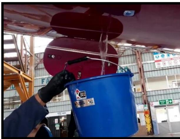
*Nota.* Se recomienda del uso de un tanque grande para el drenado de la aeronave
