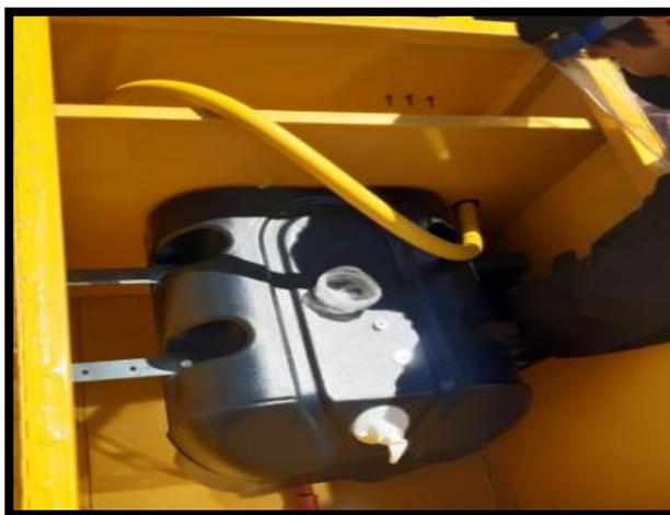
*Nota.* Tanque acoplado en la estructura con soportes L
