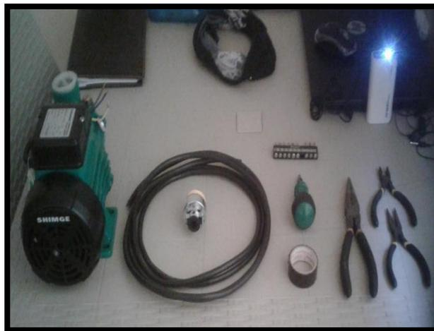
*Notas.* Componentes para conexión eléctrica de la bomba
