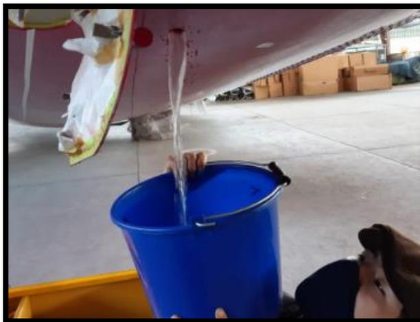
*Nota.* Revise por conexiones eléctricas debajo de la zona de drenado
