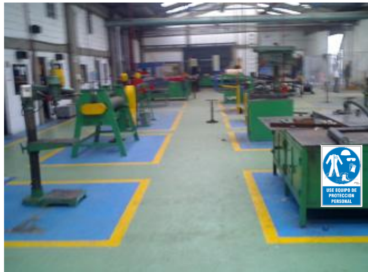
Figura 9 Señalización de áreas
