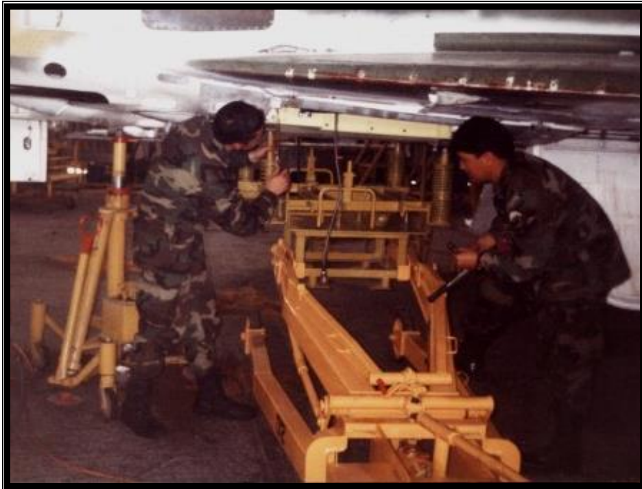
Figura 2.28. Instalación de la carretilla debajo de la caja de municiones
