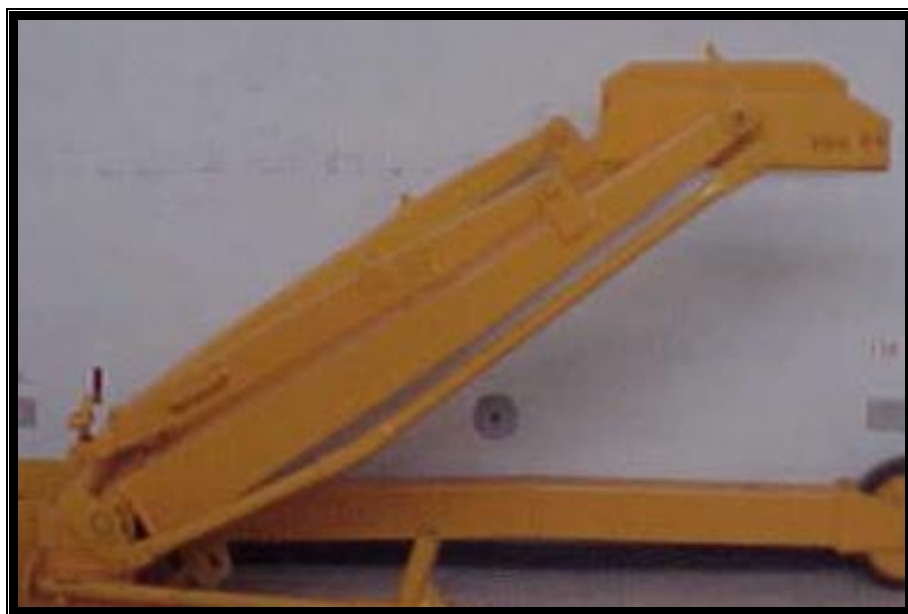
Figura 2.10. Mecanismo de estabilización de la cuna
