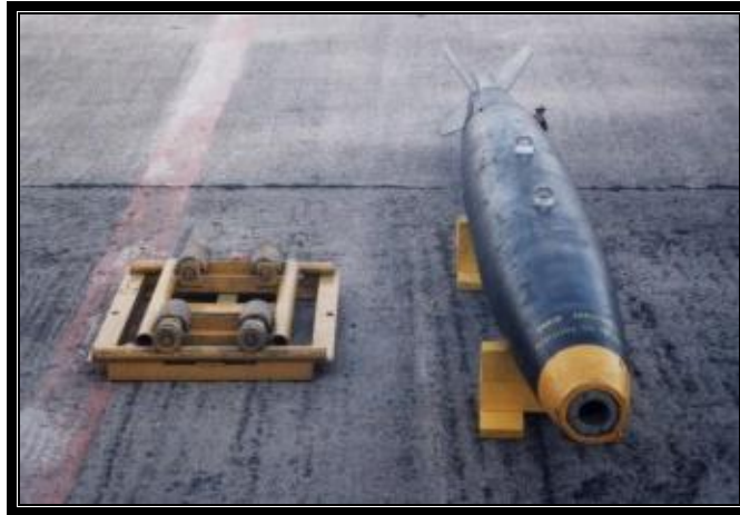
Figura 2.18. Adaptador para levantar bombas
