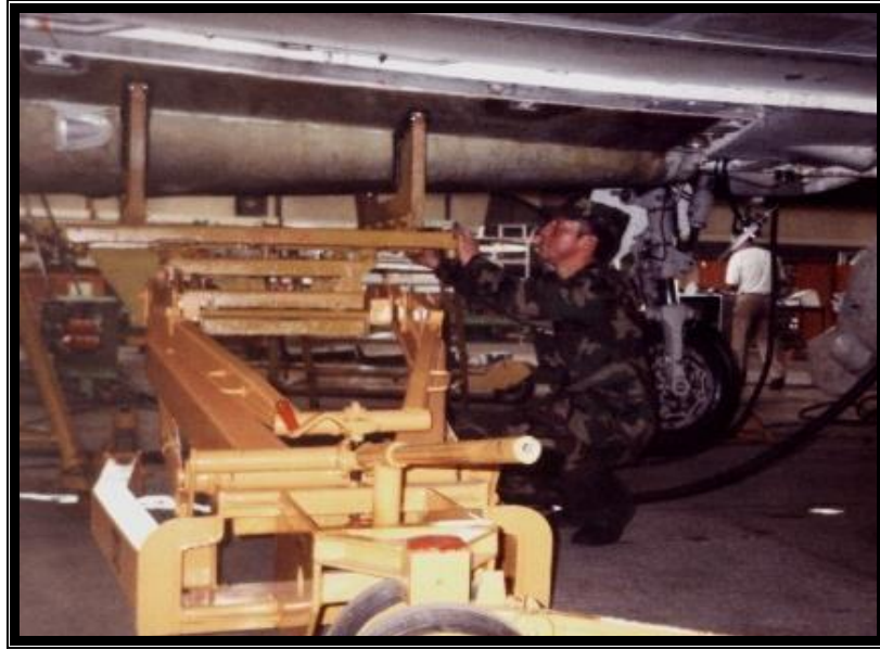
Figura 2.35. Colocación de la carretilla debajo del tanque de combustible.
