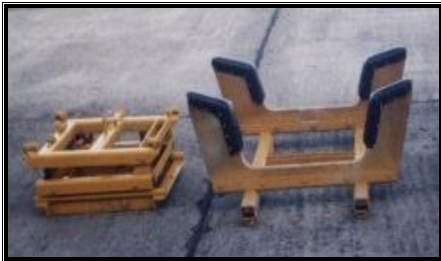
Figura 2.31. Adaptador y transportador del tanque de combustible ventral
