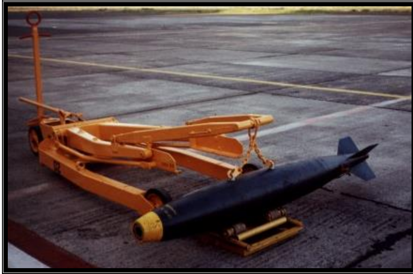
Figura 2.22. Colocación de las cadenas en la bomba.
