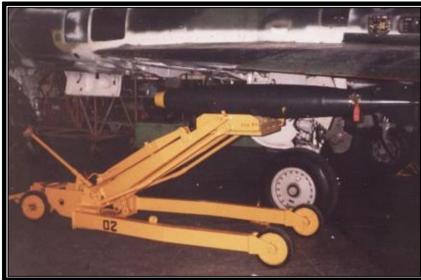
Figura 2.19. Instalación del adaptador debajo de la bomba.
