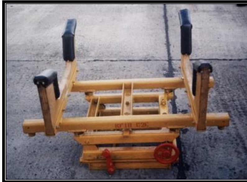
Figura 2.34: Instalación del transportador del tanque de combustible.
