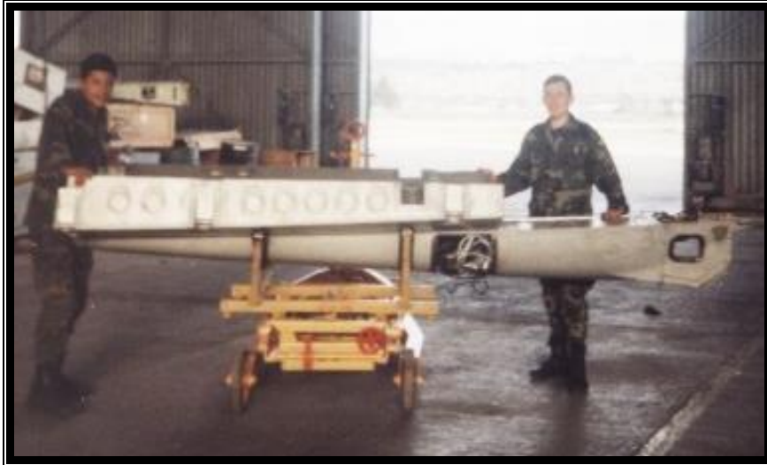
Figura 2.36. transportación del tanque de combustible
