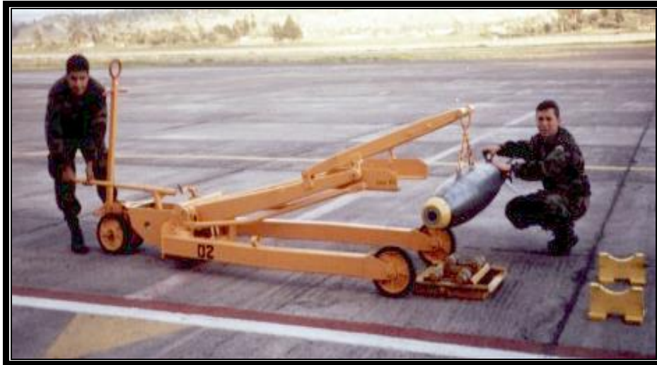
Figura 2.23. Izamiento de la bomba para transportación.
