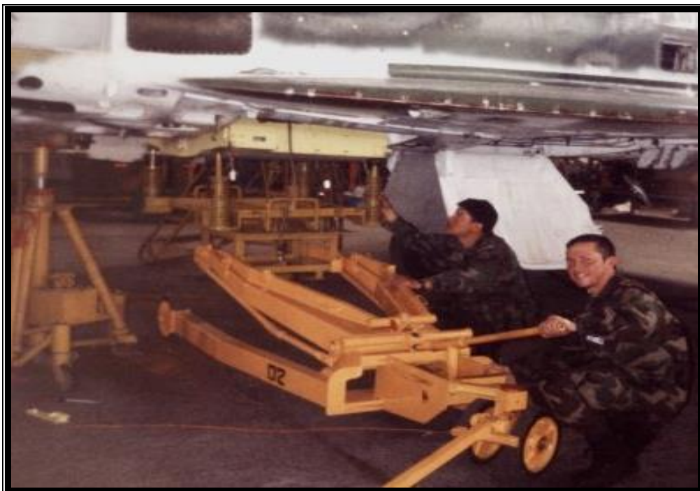
Figura 2.29. Aseguramiento de la caja de municiones.
