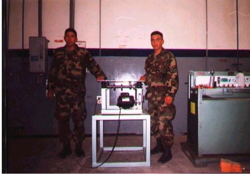
**Figura 3.31 Máquina para limpiar filtros hidráulicos tipo malla de alambre por medio de vibración.**
