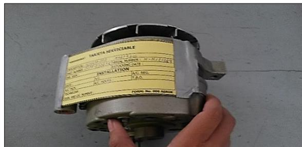
**Figura 16 Alternador Hartzell de 12 voltios****2.11.3 Motor de Arranque**
