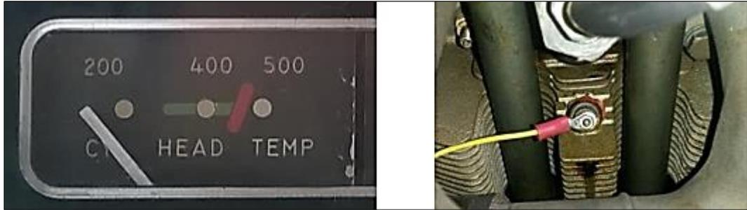
**Figura 52 Conexión del Sensor de Temperatura de Cabeza de Cilindro**
