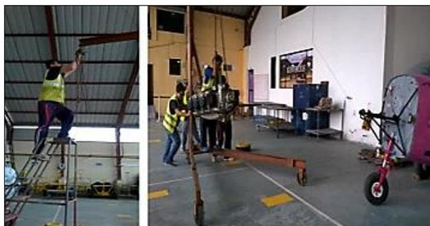
**Figura 30 Instalación del Motor**
