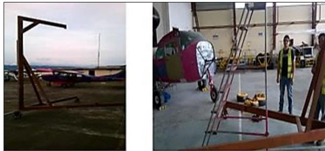
**Figura 29 Grúa Móvil de Sujeción**
