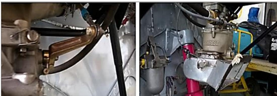
**Figura 36 Conexiones Principales de Potencia del Carburador**
