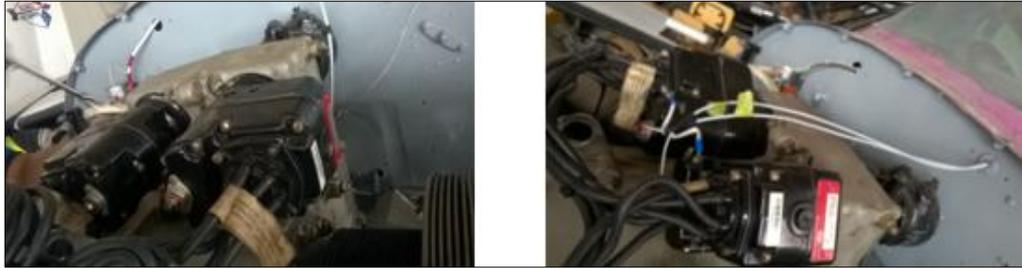
**Figura 40 Instalación y Conexión de las Magnetos en el Motor**
