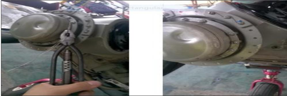
**Figura 69 Frenado del Cilindro de la Hélice**
