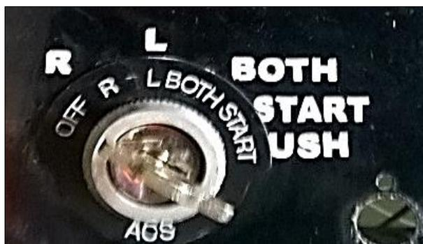
**Figura 15 Interruptor de Encendido**
