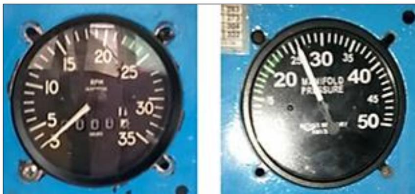
Figura 21 Indicadores de RPM e Indicador de Presión
