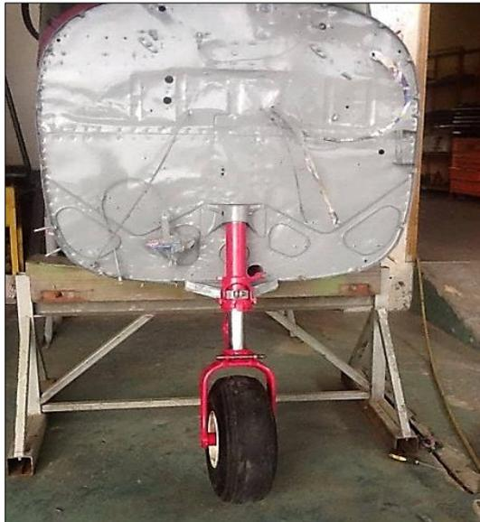
**Figura 25 Estructura del Banco de Prueba sin Engine Mount**
