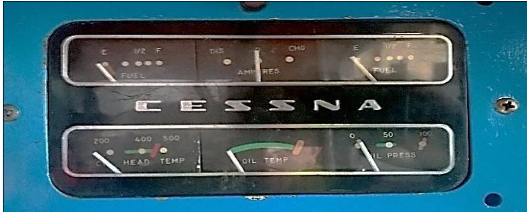
**Figura 22 Instrumentos del Motor**
