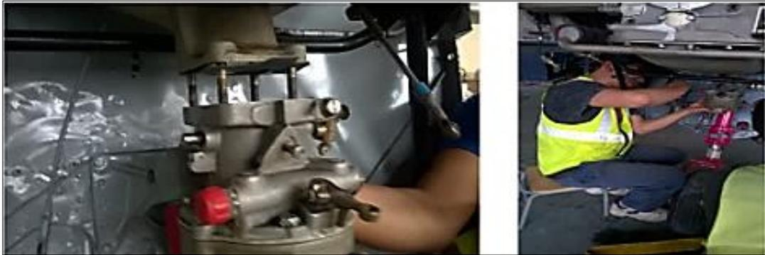
**Figura 35 Instalacion del Carburador**
