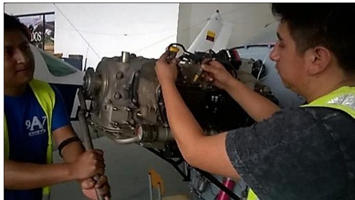
**Figura 41 Verificación de Chispa de los Cables de Ignición**
