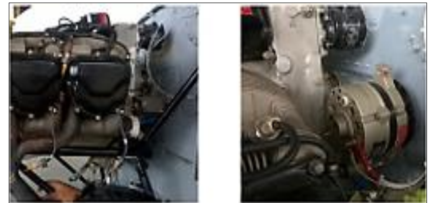
Colocación del Alternador
