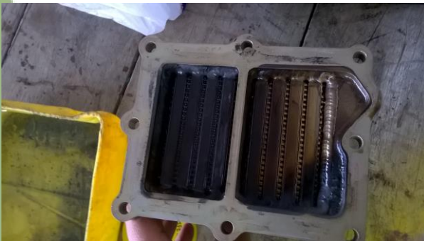
Limpieza del Oil Cooler y su Sección en el Motor
