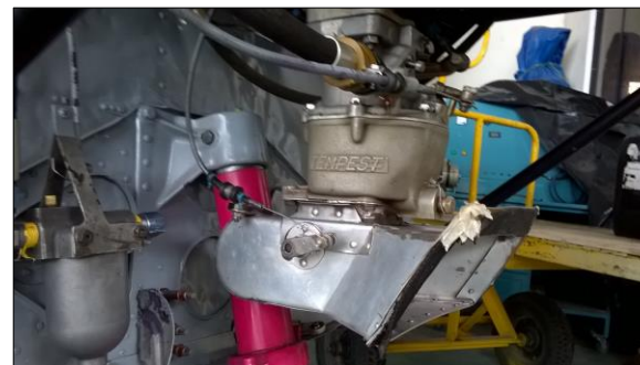
Instalación de la toma de aire
