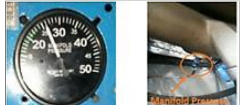
Instalación del Manifold Pressure
