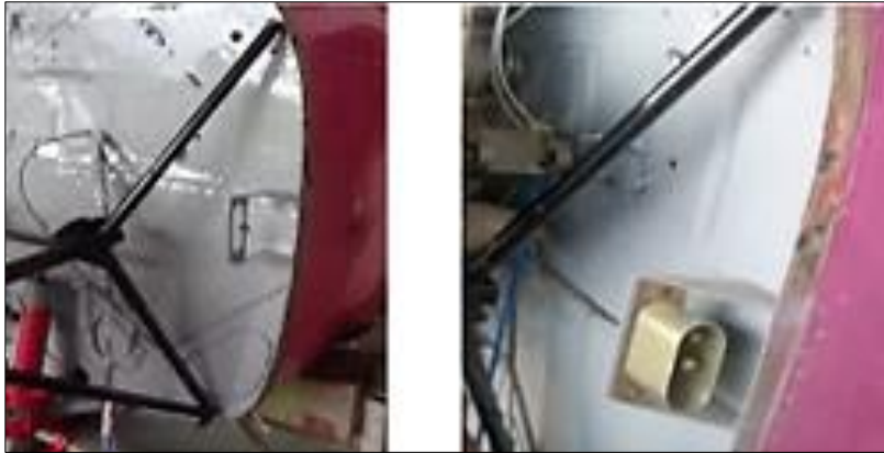
Colocación de la Fuente Externa
