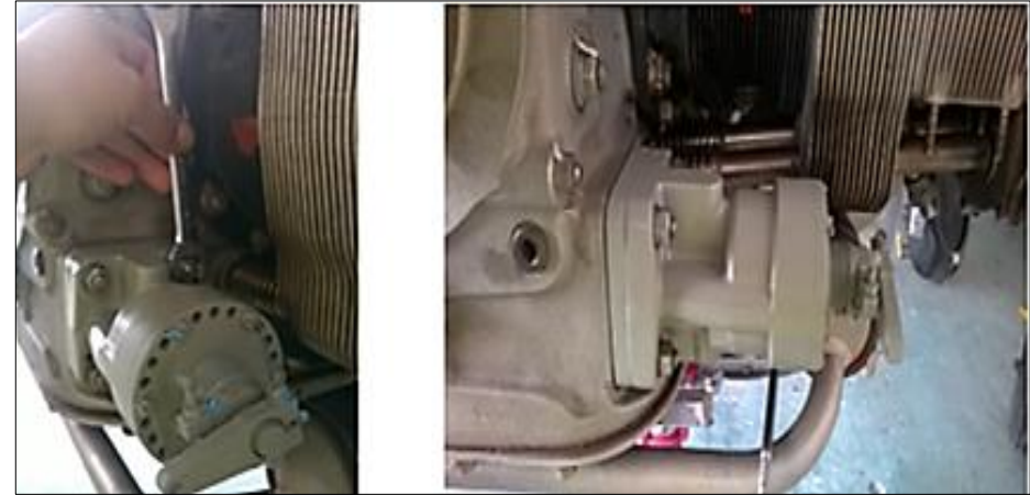
Instalación de Gobernador en el Motor
