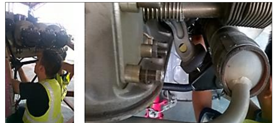
Ajuste de las Bases del Motor al Engine Mount
