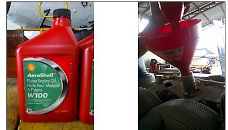
Colocación del aceite en el Motor
