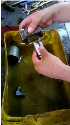
Limpeza del filtro
