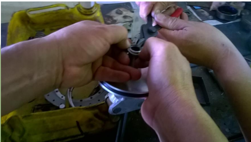
Ensamblaje del Pistón de la Hélice
