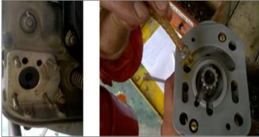
Colocación de Lubricante en el Gobernador
