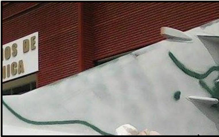
Aplicación finalizada del fondo en el empenaje
