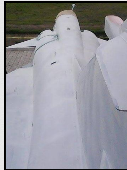
Aplicación finalizada del fondo en el avión
