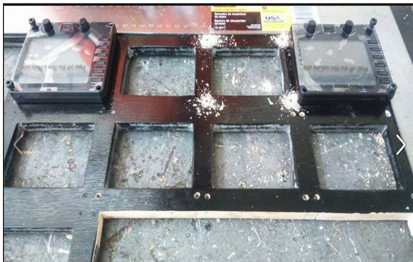
Figura 47 Perforaciones para el anclaje de los instrumentos
