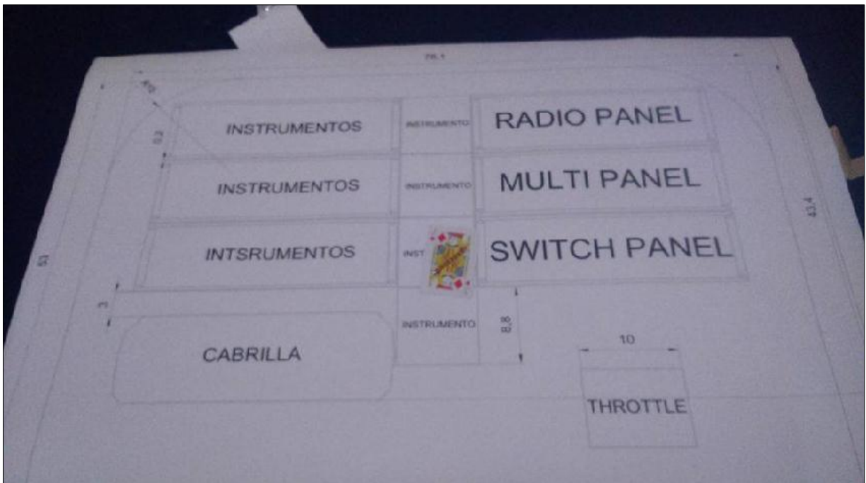
Figura 41 Impresión tamaño real del panel tipo Cessna
