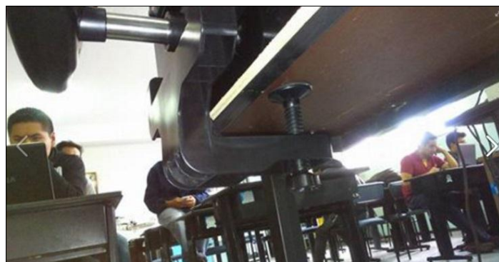
Figura 49 Fijación de la cabrilla a la estructura
