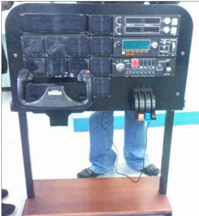
Figura 52 Panel tipo Cessna finalizado
