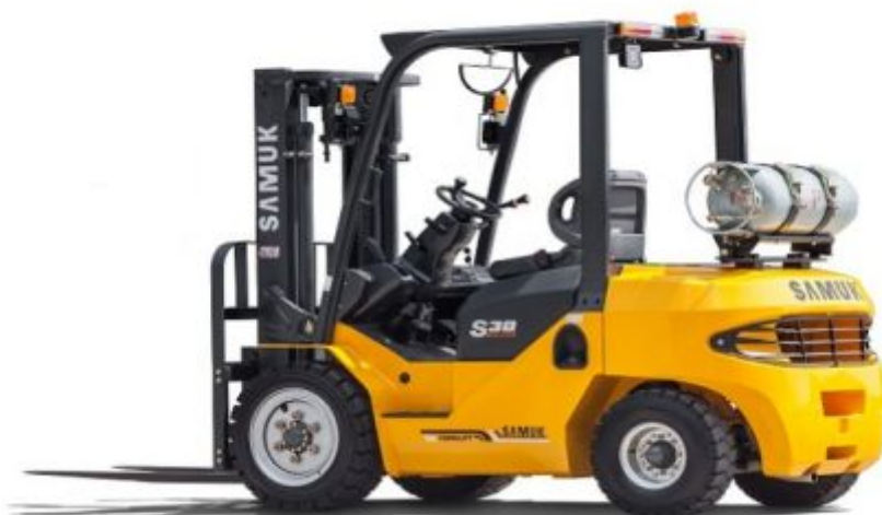
Figura 28 Carretilla elevadora de gas propano que utiliza la empresa Distriolmedo Cía. Ltda. Para la actividad de carga y descarga del producto.
