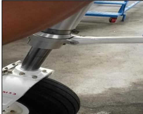
**Figura 125** Montaje de los ejes del Steering bungee
