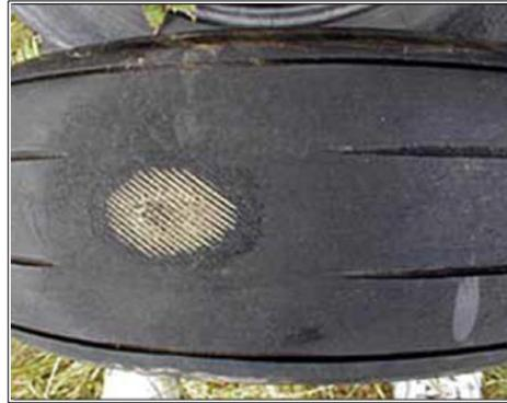
**Figura 23** Banda de rodadura desgastada
