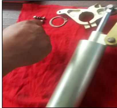
**Figura 105** Inspección del shimmy damper
