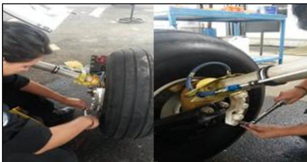
**Figura 80** Uso de Torquímetro
