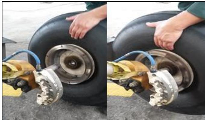
**Figura 76** Montaje del neumático
