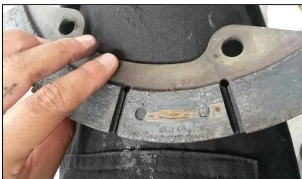
**Figura 63** Inspección de la placa de sujeción
