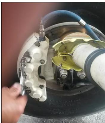
**Figura 79** Fijación del conjunto de frenos
