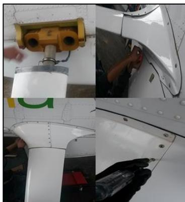
**Figura 85** Instalación de carenados
