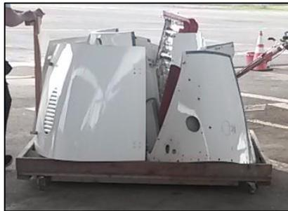
**Figura 104** Inspección de carenajes
