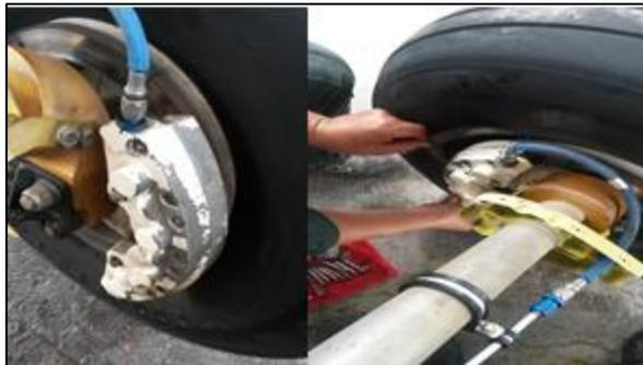
**Figura 78** Colocación del conjunto de frenos
