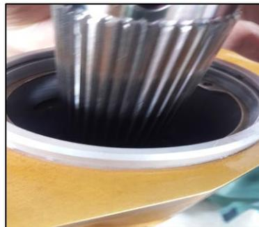
**Figura 115** Inserción del tubo de dirección
