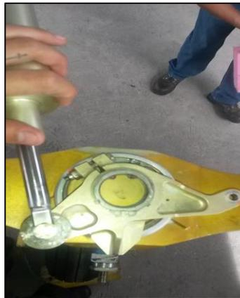
**Figura 121** Montaje del Shimmy damper
