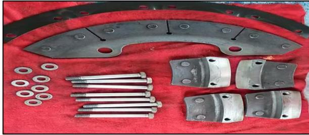
**Figura 77** Elementos del conjunto de frenos
