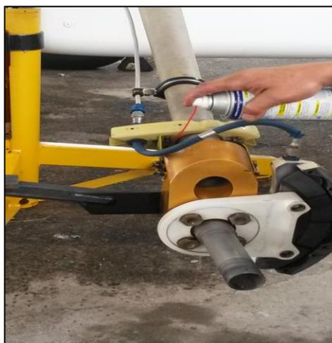
**Figura 56** Inspección del tubo de la pata del tren principal
