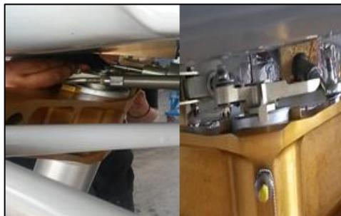
**Figura 124** Montaje de los ejes del Shimmy damper
