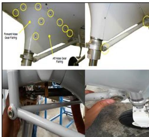
**Figura 89** Puntos de sujeción de carenados
