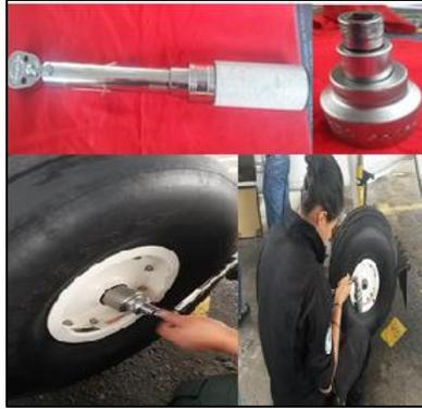
**Figura 81** Colocación del perno de la rueda
