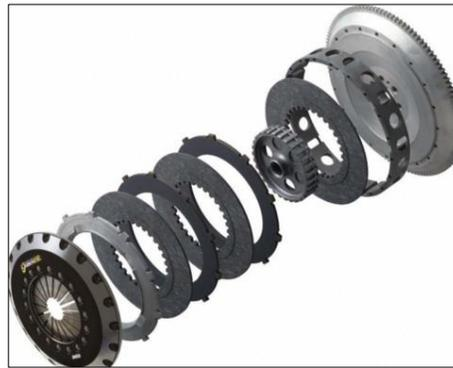
**Figura 34** Partes del freno Multidisco
