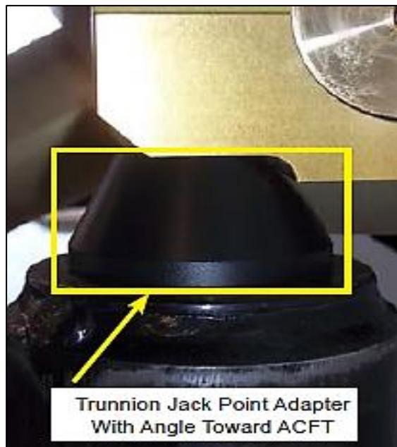
**Figura 41** Adaptador del punto de levantamiento del Trunión
