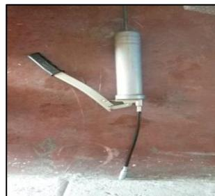
**Figura 71** Pistola de grasa con Aeroshell Grease 22
