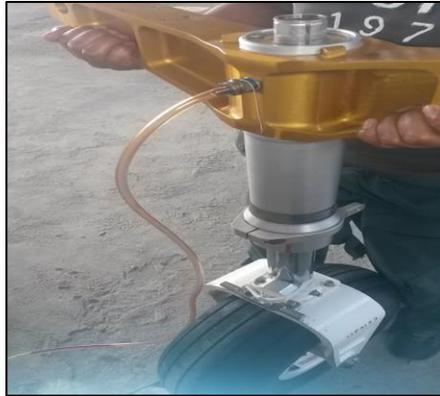
**Figura 101** Vaciado de fluido hidráulico
