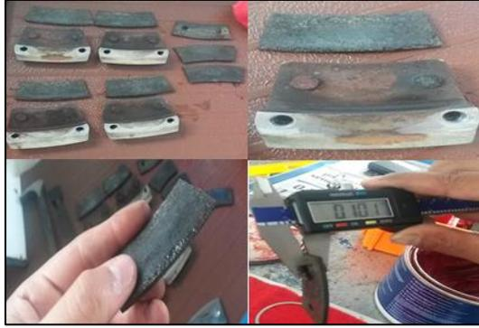
**Figura 66** Inspección de los Linings
