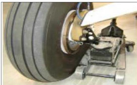
**Figura 7** Punto de levantamiento del eje del tren de aterrizaje principal
