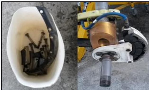
**Figura 62** Remoción de elementos del conjunto de frenos
