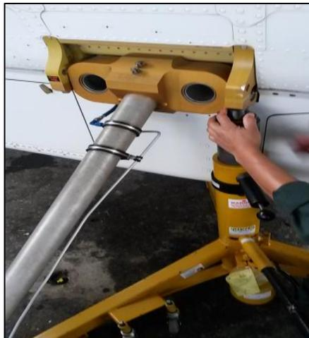
**Figura 42** Levantamiento del tren principal en el punto del trunión #1
