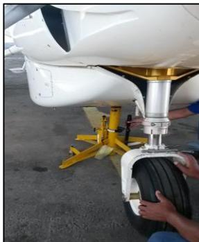
**Figura 88** Colocación en gatos de la aeronave
