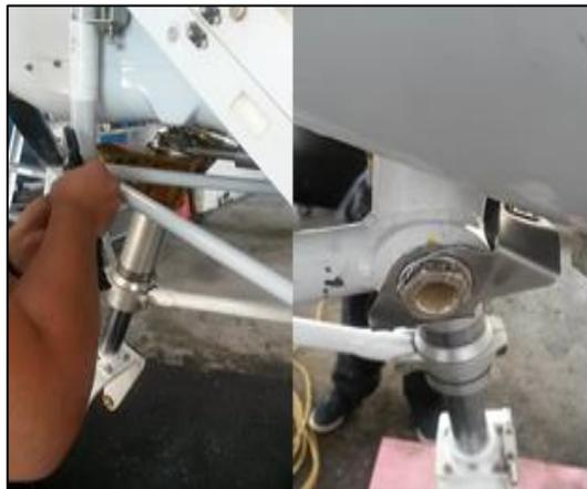
**Figura 126** Frenado de tuerca de sujeción
