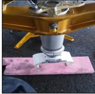
**Figura 122** Montaje del Shock Strut
