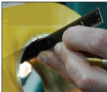
**Figura 58** Inspección del GAP del trunión
