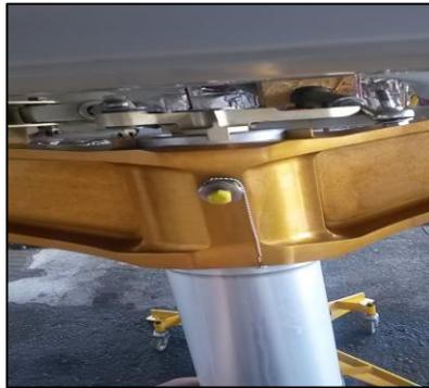
**Figura 116** Tapa protectora de la válvula de alta presión
