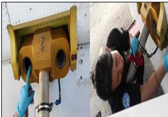
**Figura 54** Inspección Visual del Trunión
