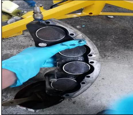
**Figura 64** Inspección de cañerías y placa de frenos
