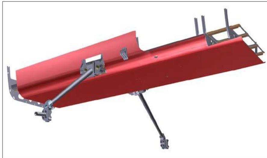
**Figura 8** Instalación del tren de aterrizaje principal
