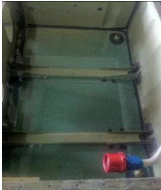
Figura 80 Prueba de fugas de combustible
