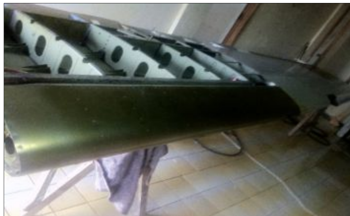
Figura 71 Remachado de la piel en las costillas de borde de ataque
