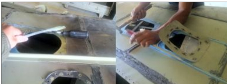
Figura 59 Remoción de los marcos de tapas de inspección
