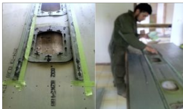
Figura 78 Aplicación de sellante PRC a los larguerillos del ala
