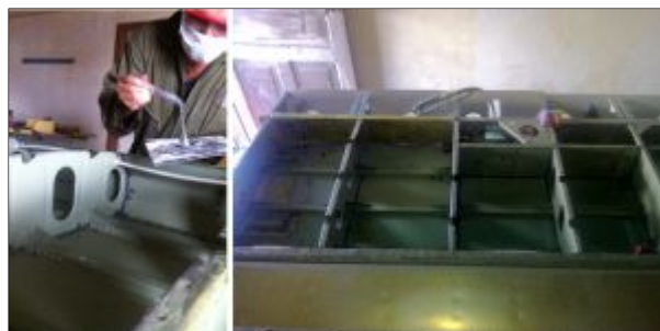
Figura 79 Colocación de PRC en costillas y remaches del depósito de combustible
