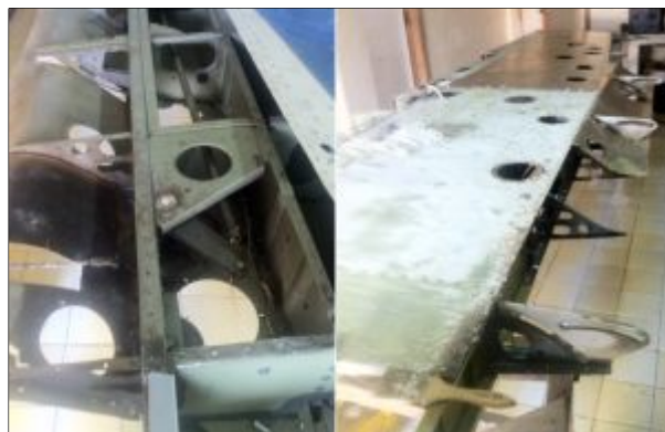
Figura 48 Remoción de piel inferior del borde de salida
