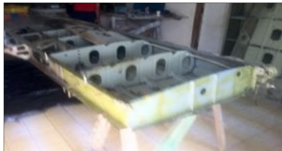
Figura 67 Colocación de la viga principal del ala
