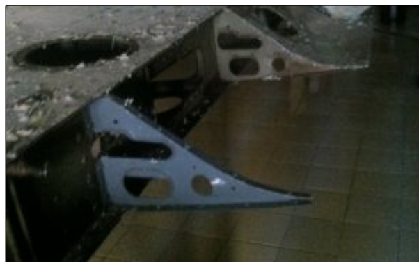
Figura 64 Remachado de costillas de borde de salida
