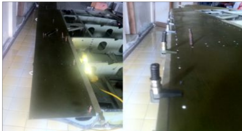
Figura 73 Remachado del borde de salida del plano
