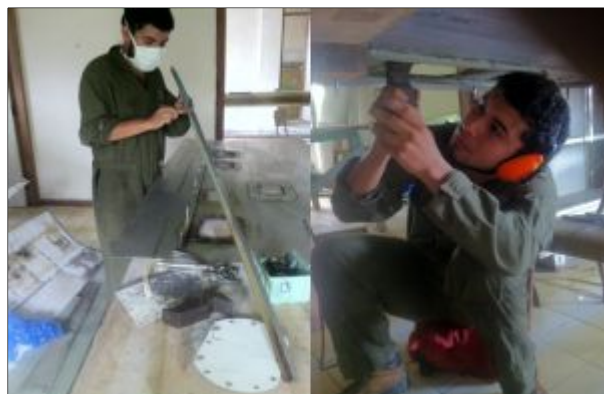
Figura 77 Remachado de larguerillos del plano
