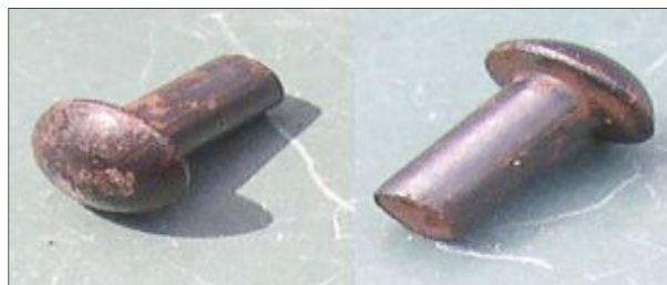
Figura 17 Remache de cabeza redonda
