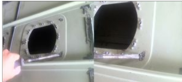
Figura 57 Remoción del sellante de los remaches
