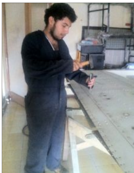
Figura 60 Extracción de la lámina superior
