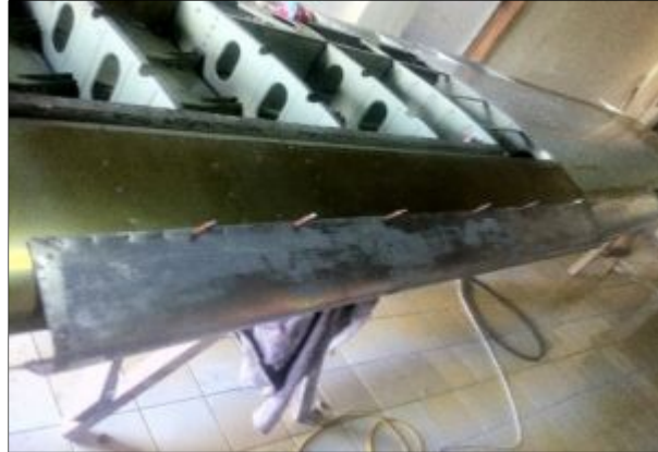
Figura 72 Remachado de extensión de borde de ataque
