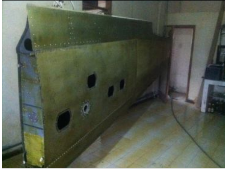
Figura 83 Reconstrucción del ala izquierda finalizada
