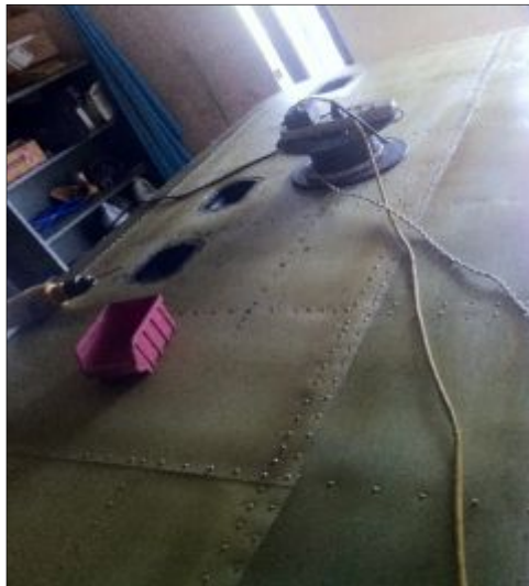
Figura 82 Remachado de la lámina superior del tanque de combustible
