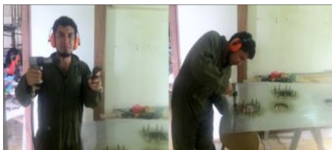
Figura 76 Remachado de marcos de las tapas de inspección
