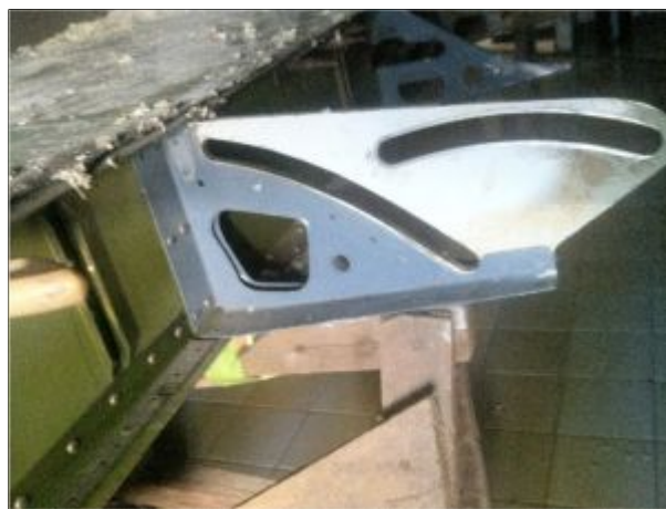
Figura 65 Remachado del riel de recorrido del flap
