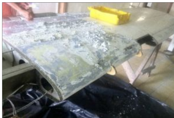
Figura 55 Retirado de pintura
