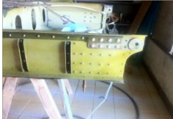
Figura 66 Empalme en la viga
