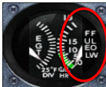
Figura 6 Indicador de Flujo de Combustible
