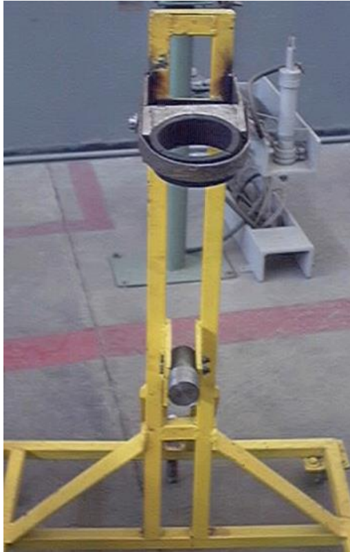
Figura 3.6. Estructura en donde se sujeta la pata del tren y conjunto de frenos
