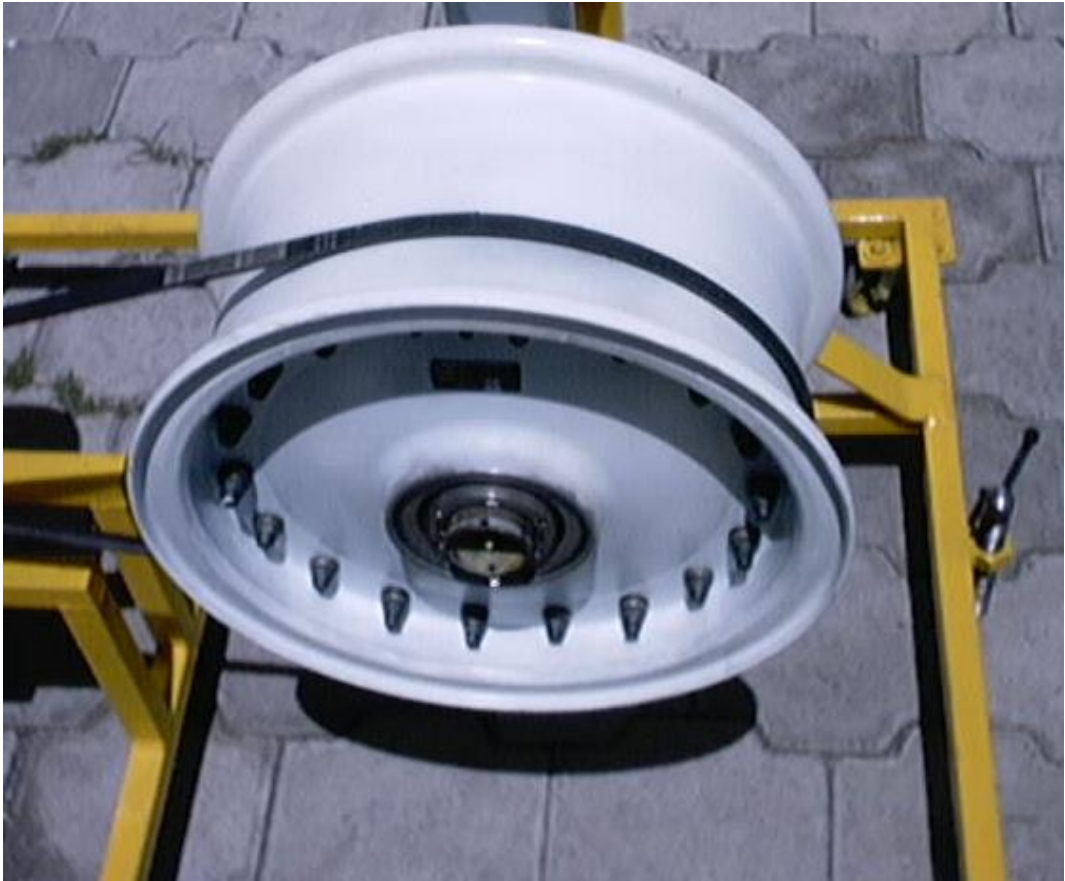
Figura 3.18 Instalación del tambor
