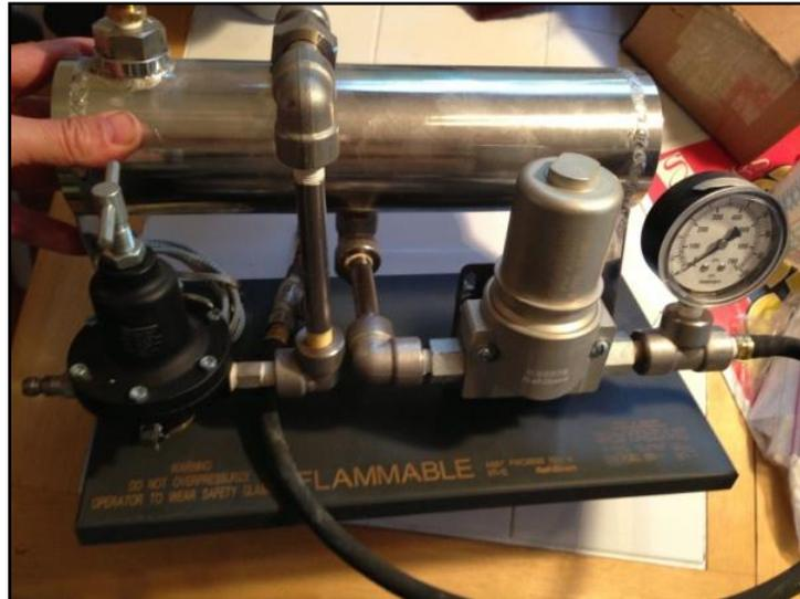
**Figura 2.12** Banco de pruebas para inyectores.
