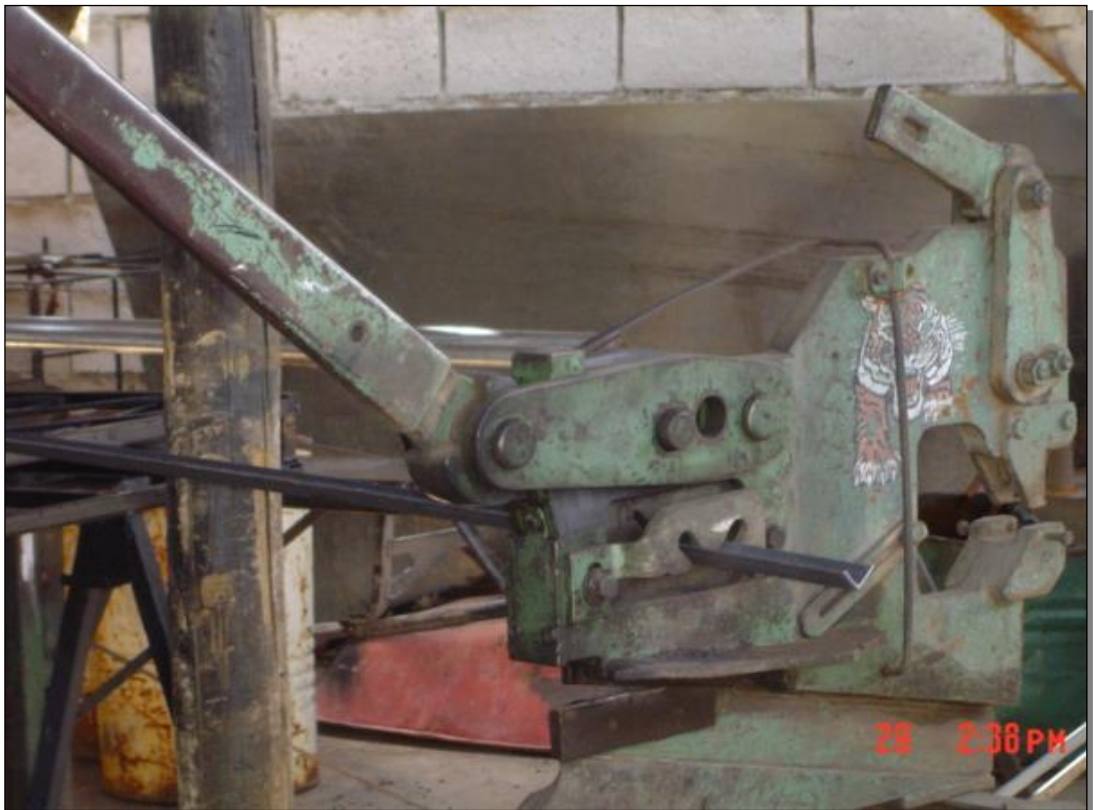
Fig. 3.14. Corte del Ángulo, haciendo uso de la cizalla
