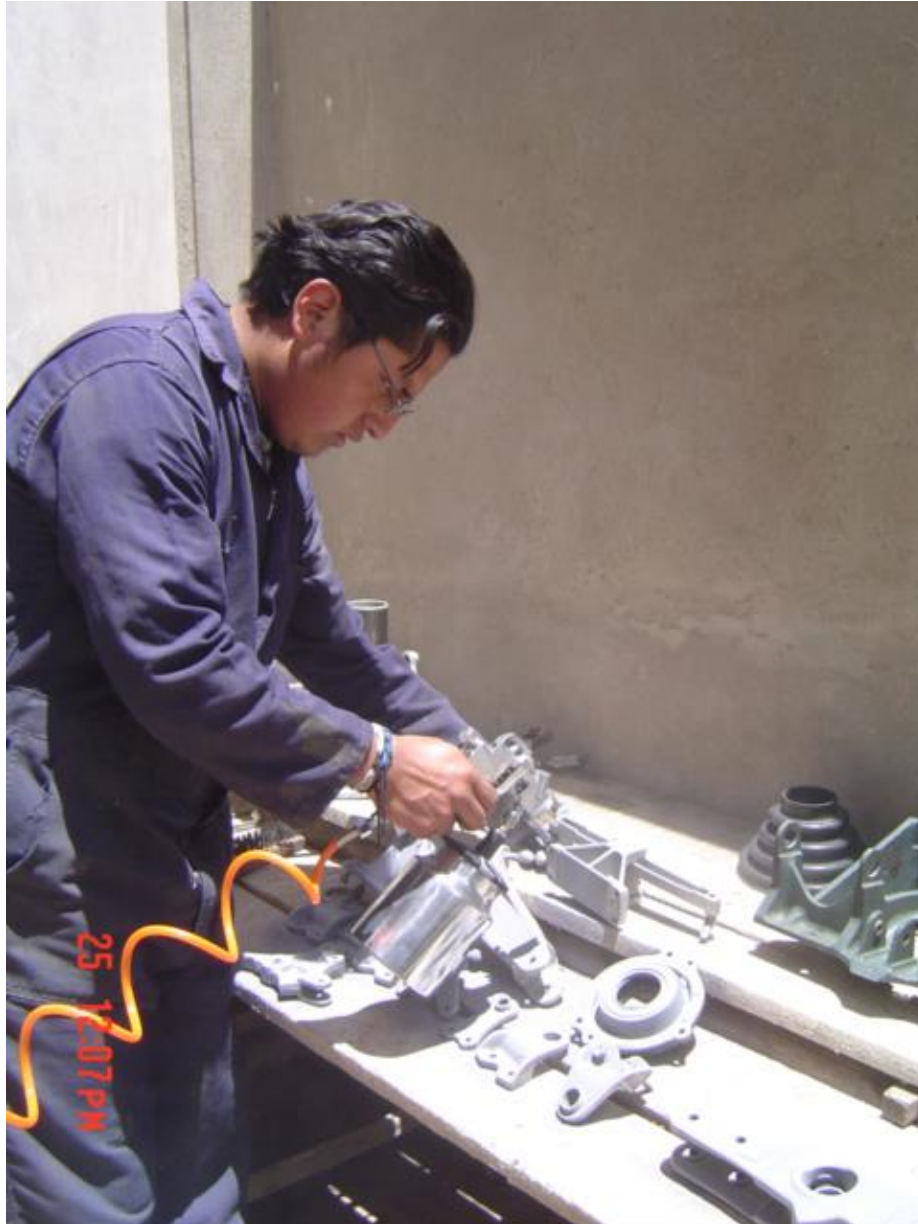
Fig. 3.26. Aplicación del fondo gris con soplete sobre las piezas del helicóptero.
