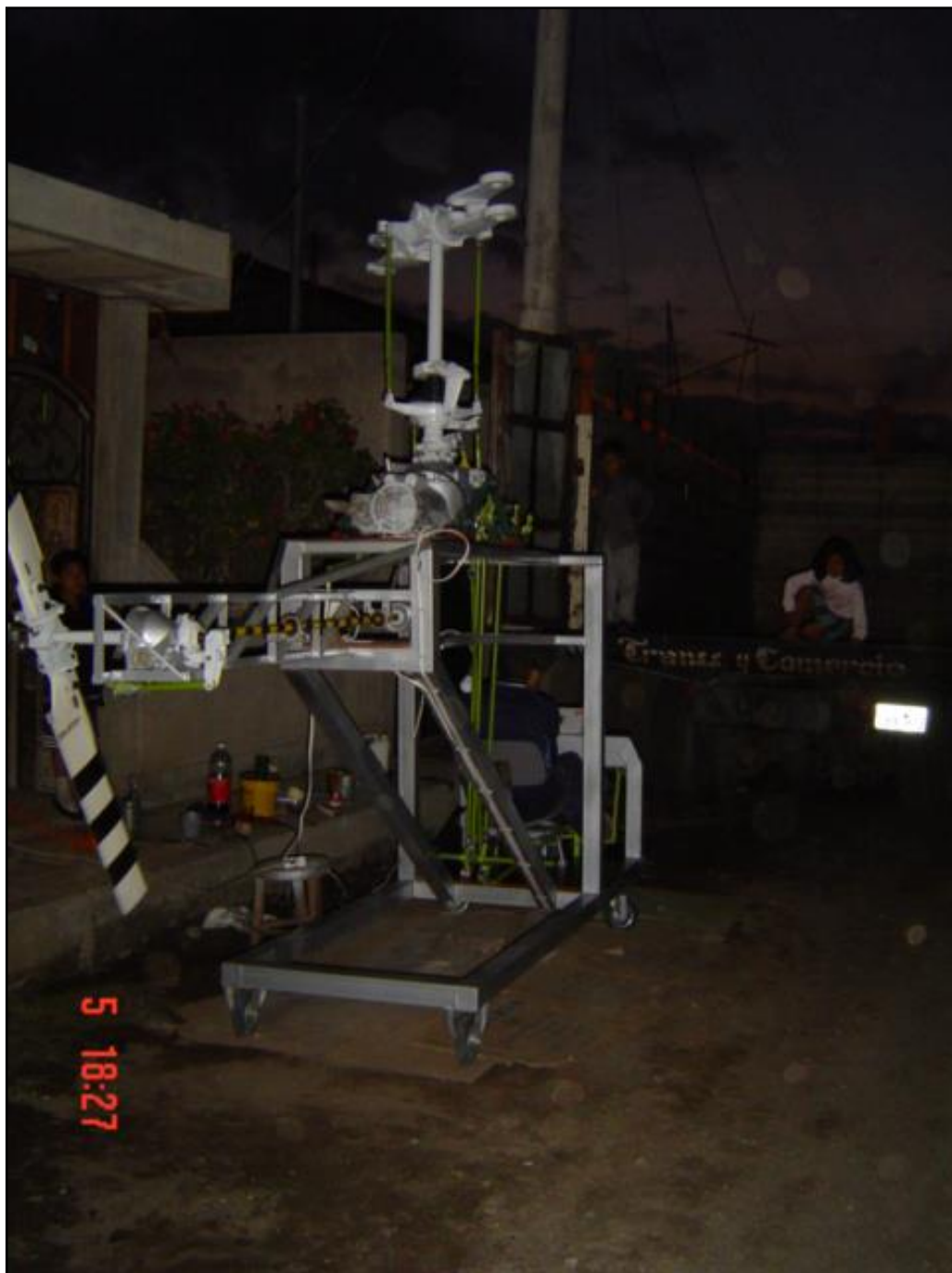
Fig. 3.38. Comprobación del rotor de cola.
