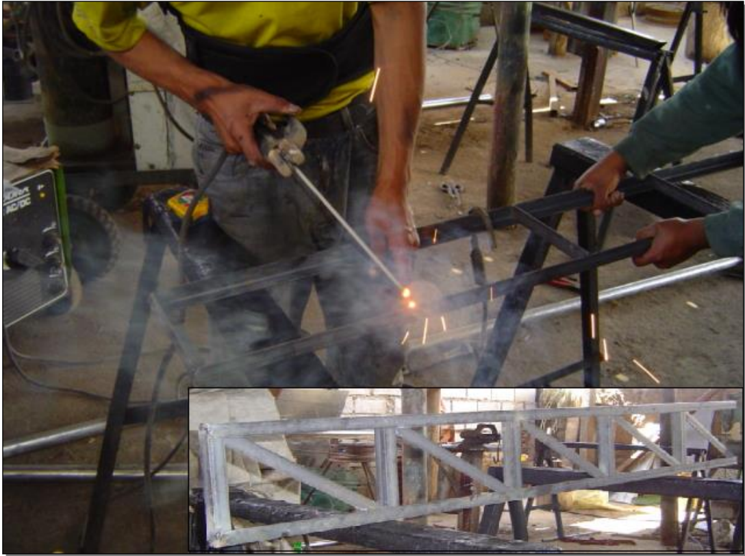
Fig.3.15. Soldado del soporte de rotor de cola.
