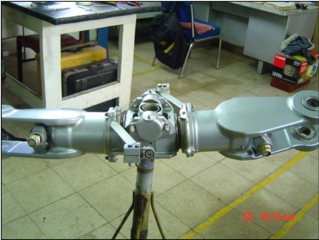
Fig. 3.32. Armado del Rotor Principal
