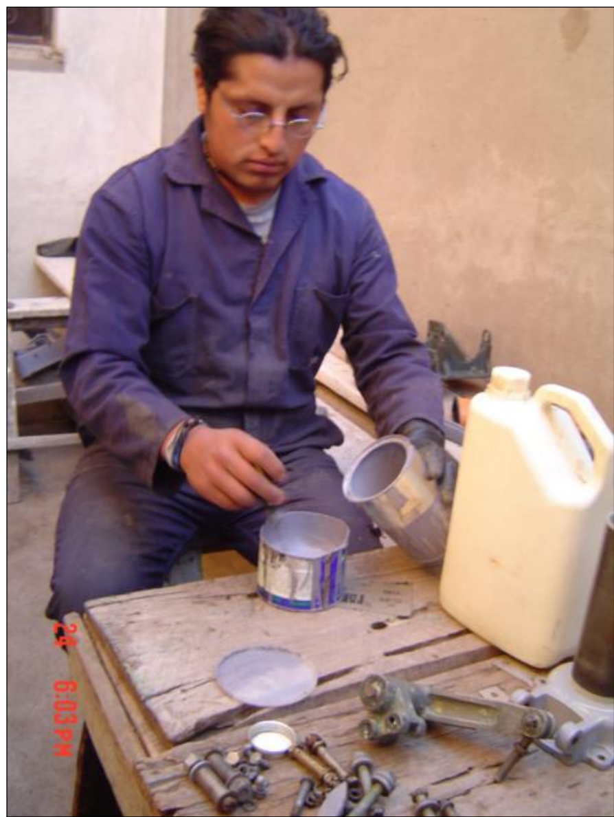
Fig. 3.25. Preparación del fondo gris anticorrosivo.
