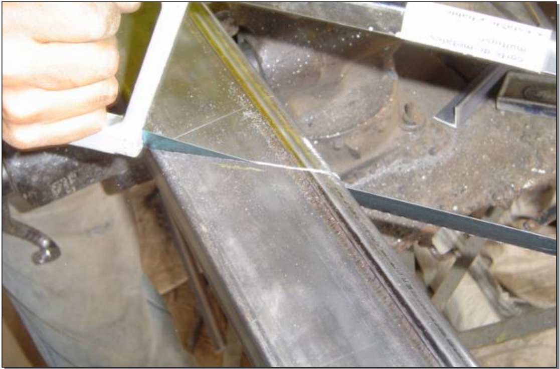
Fig.3.13. Corte del perfil a 45°
