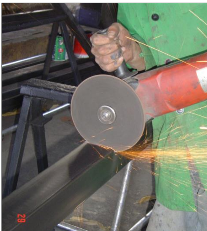
Fig. 3.11. Corte del perfil "G"
