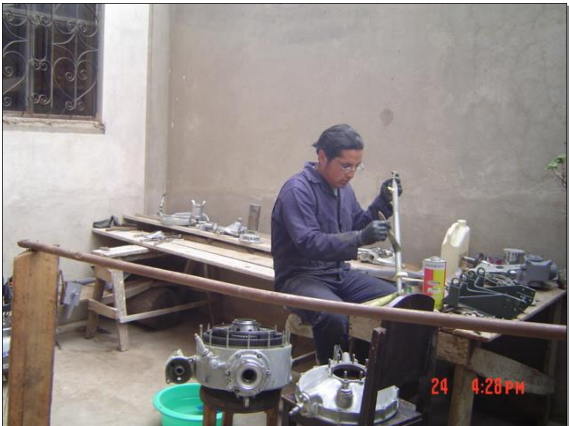
Fig 3.24. Limpieza de las partes del helicóptero y remoción de la pintura aplicando removedor.
