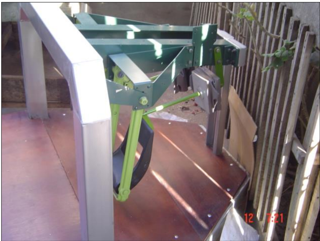
Fig. 3.33. Montaje de los mecanismos de control de vuelo.
