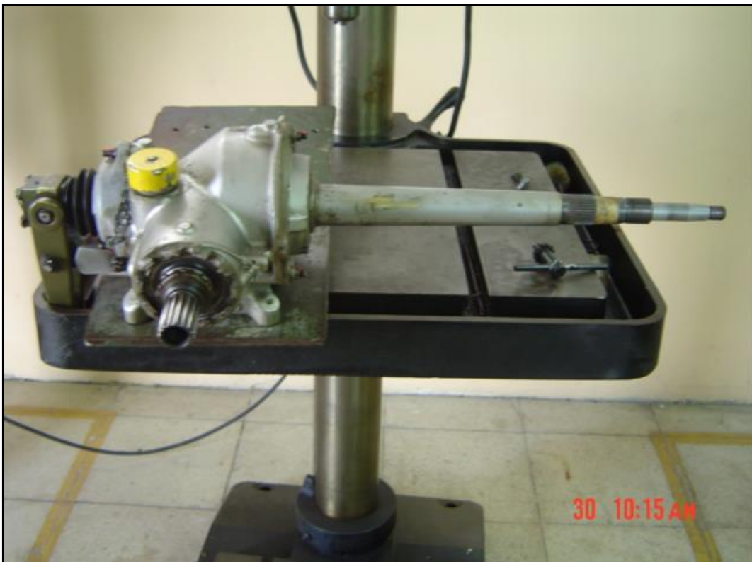
Fig.3.31. Armado del rotor de cola.
