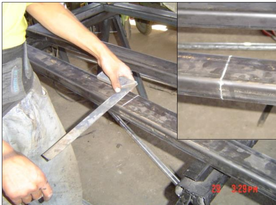
Fig. 3.10. Trazado para corte del perfil.
