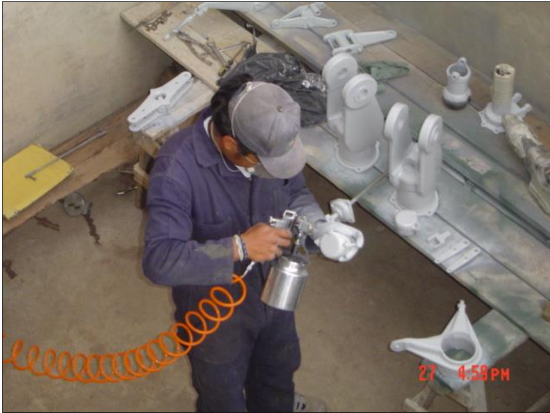
Fig. 3.27. Aplicación de la primera capa de pintura.
