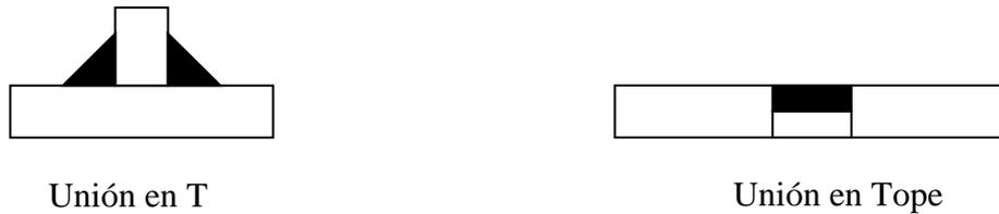
**Figura3.11. Tipos de soldadura utilizados en la construcción.**
