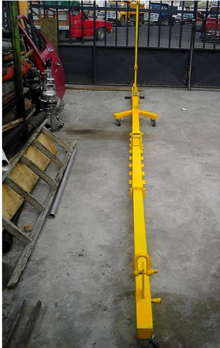
**Figura. 3.12. Banco de recuperación y enderezado de chasis y compactos para vehículos livianos en la parte estructural terminado.**
