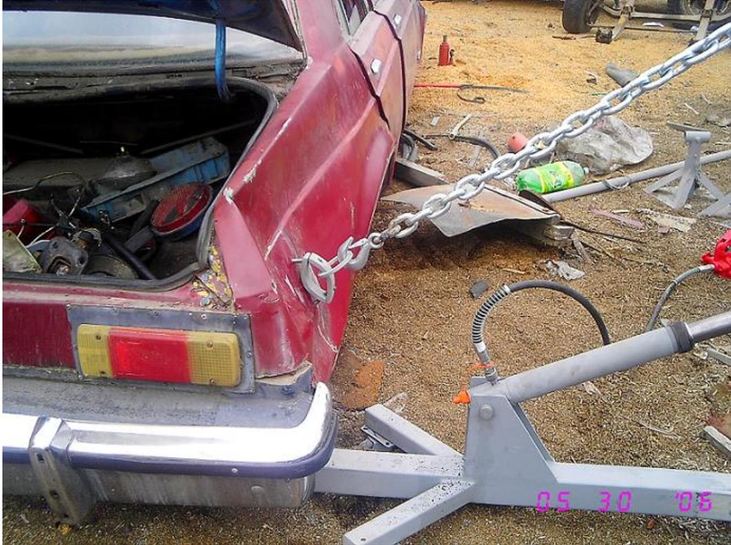
**Figura 3.13. Banco en recuperación y enderezado de chasis y compactos para vehículos livianos en funcionamiento.**
