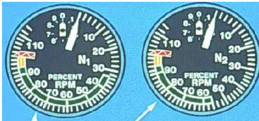
Figura 2.43 Indicadores de porcentaje de revoluciones del compresor de baja (N1) izquierda, compresor de alta (N2) derecha.
