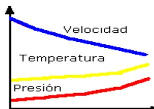
Figura 2.8. Diagrama P-V-T en la toma de aire.
