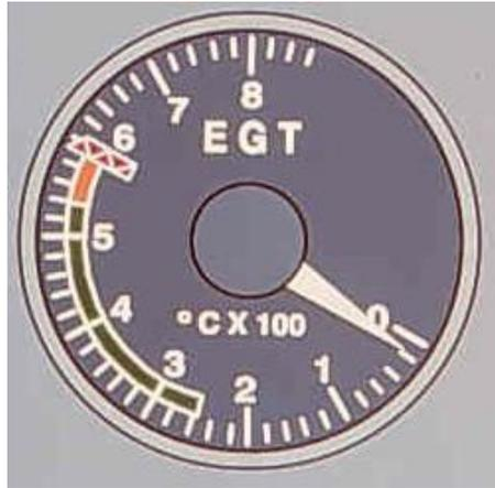
Figura 2.45 Indicador de temperatura de gases de escape
