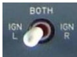
Figura 2.49 Tablero de control de ignición del motor.
