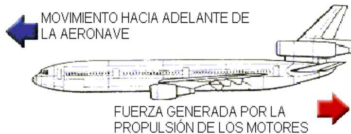
Figura 2.2 Fuerza de acción y reacción en una aeronave
