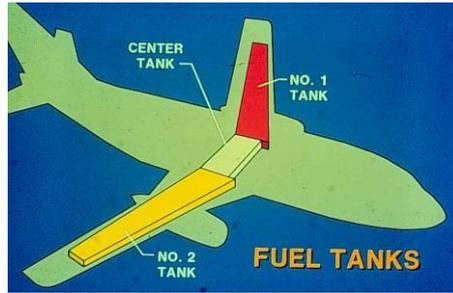
Figura 2.21 Configuración de los tanques de combustible de la aeronave Boeing 737.
