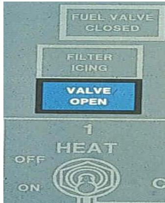
Figura 2.19. Interruptor de paso de aire al intercambiador de calor del sistema de combustible.
