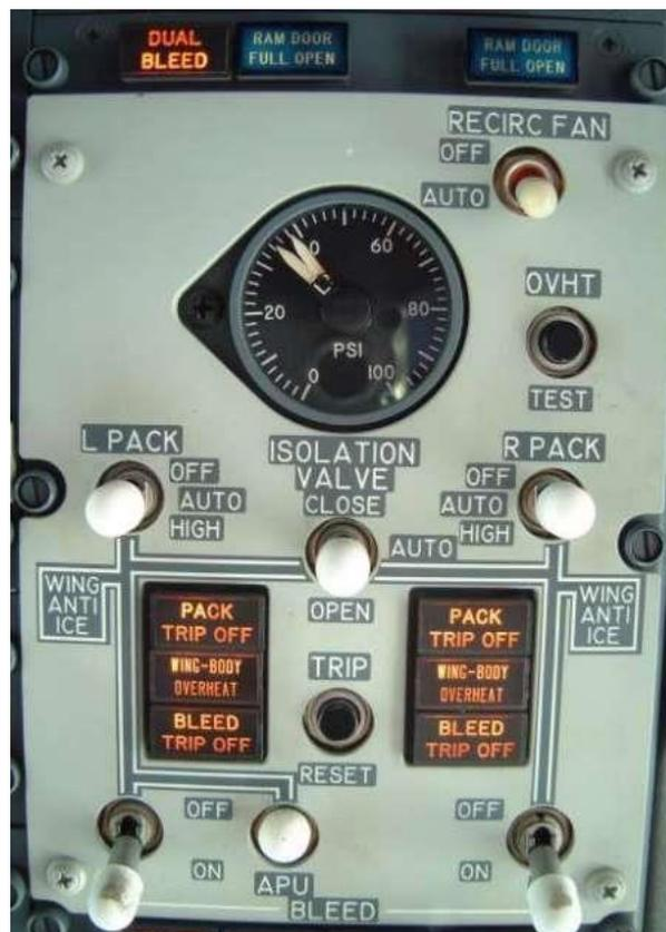
Figura 2.47 Tablero de control de aire neumático para el arranque del motor
