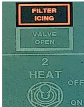
Figura 2.28 Indicación de filtro de combustible obstruido
