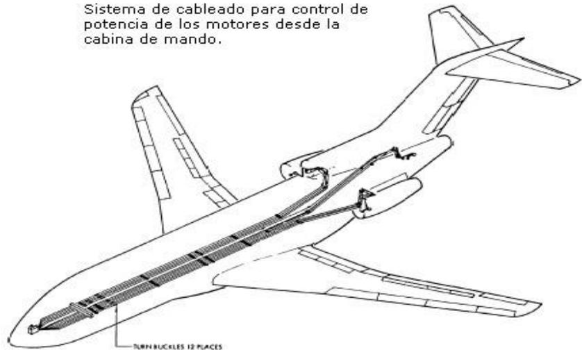
Figura 2.23 Configuración de control de la unidad de control de combustible.
