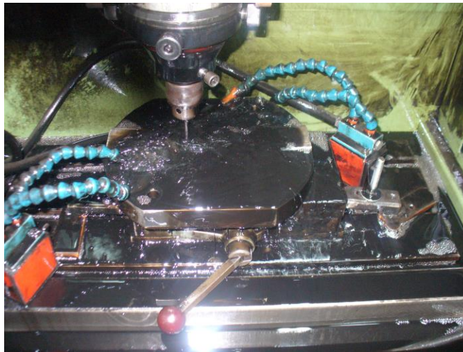
Fig. 3.4 Drenaje del líquido dieléctrico (Diesel)
