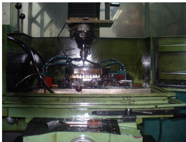
Fig. 3.1. Máquina de electroerosión
