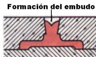
Fig. 1.11. Contracción de solidificación
