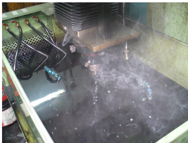
Fig. 3.3. Desbaste por electroerosión
