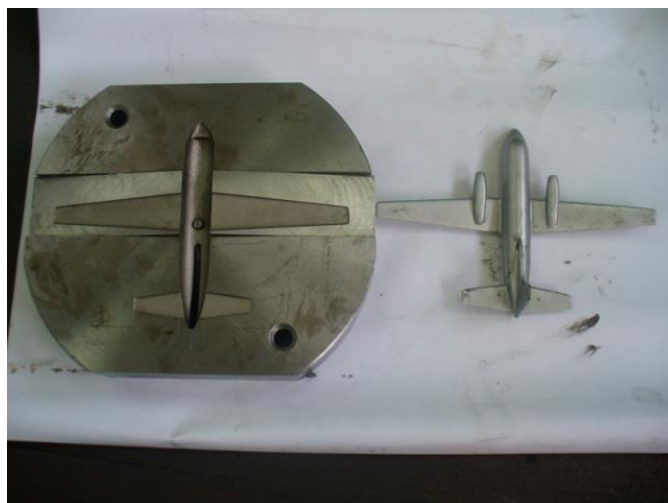
Fig. 3.5. Molde sin desbaste del motor
