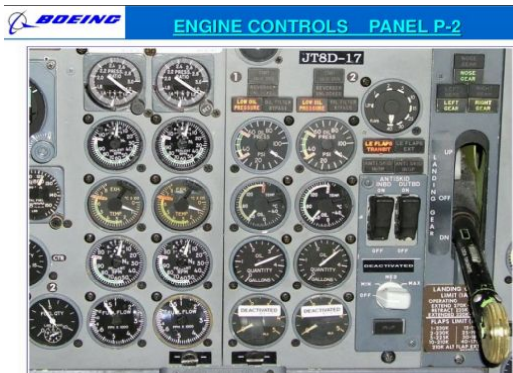
Figura 2. 26: Panel p2 del Boeing 737-200
