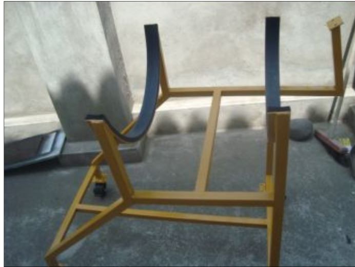
Figura 3. 21: Colocación de cauchos protectores
