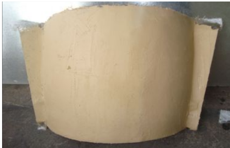
Figura 3. 13: Masillado de compuertas
