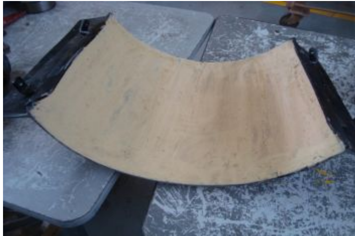
Figura 3. 15: Masillado y lijado de la parte interior de la Clamshell doors
