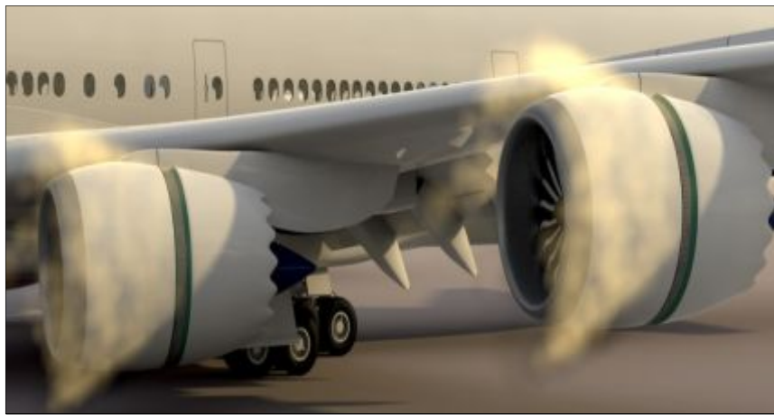
Figura 2. 13: Reversa tipo cascada doors
