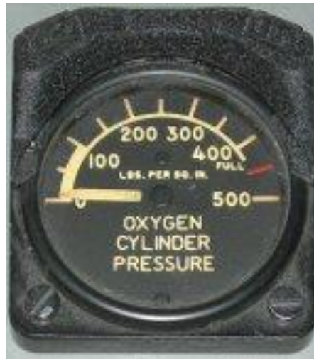
Figura 3.25 Indicador de presión de oxígeno.
