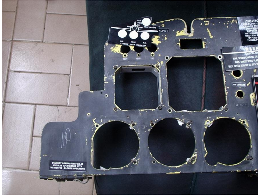
Figura 5.1 Panel de control deteriorado
