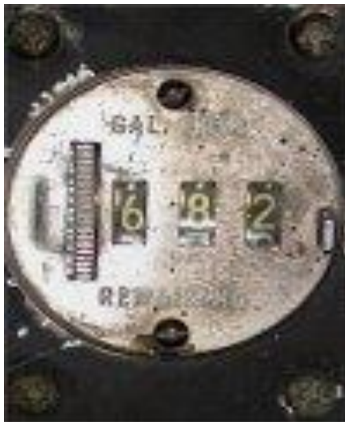
Figura 3.27 Indicador restante del “combustible”
