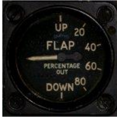
Figura 3.19 Indicador de flaps.
