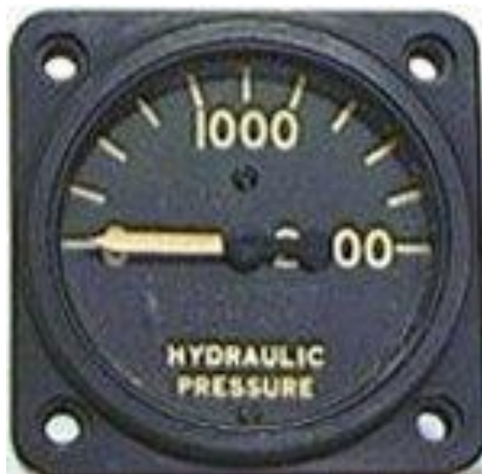
Figura 3.23 Indicador de presión hidráulica
