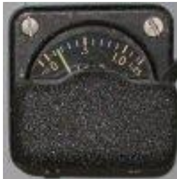
Figura 3.28 Metro de la carga del generador
