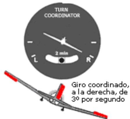
Figura 3.8 Lectura del indicador de viraje.
