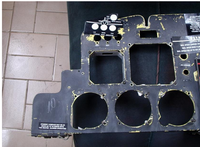
Figura 2.2 Panel de control deteriorado
