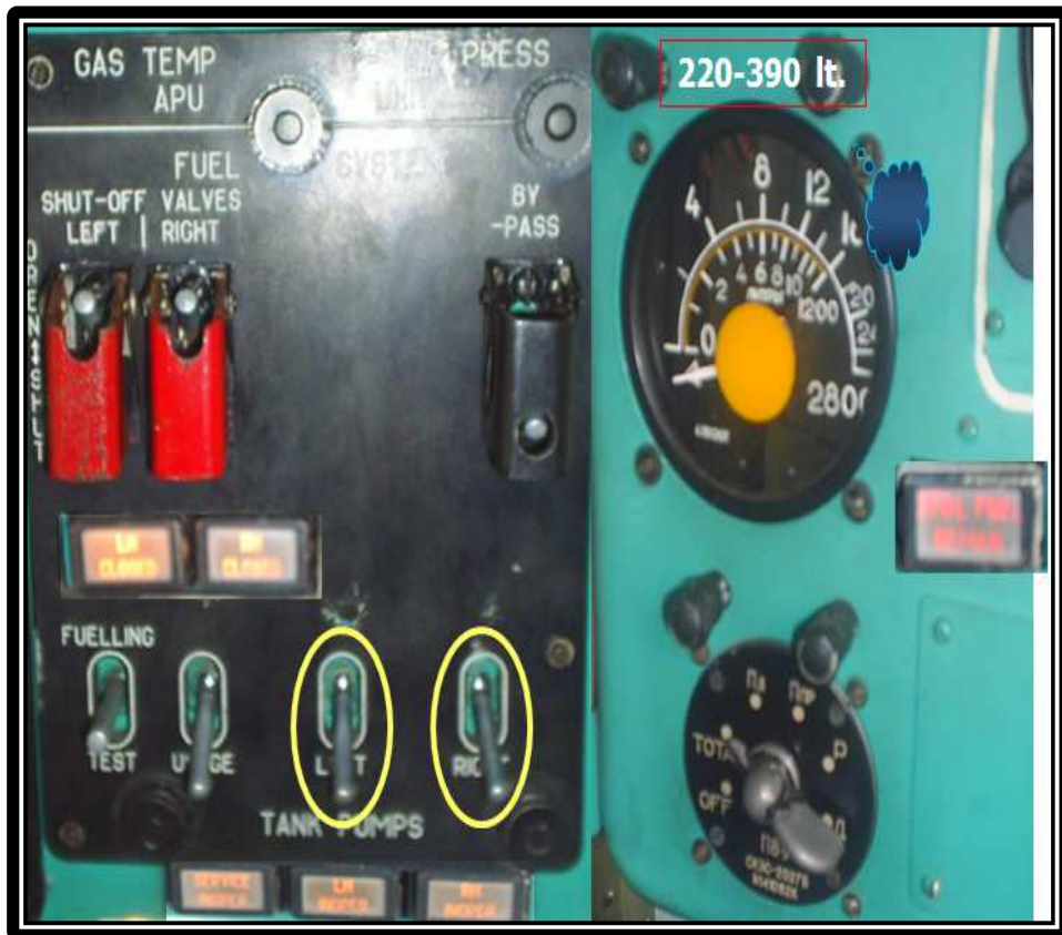
Figura 2. 47: Acciones en caso de atrancamiento de la válvula flotadora
