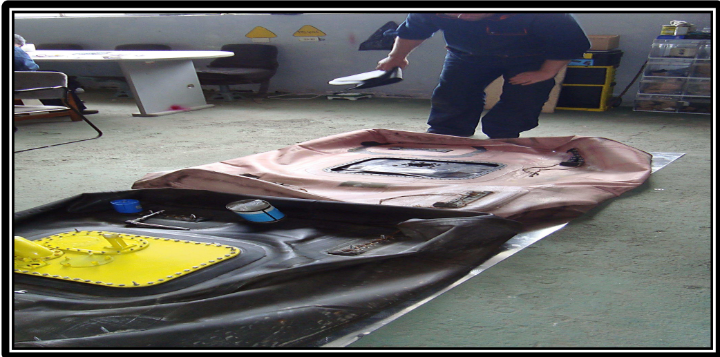
Figura 2. 8: Tanque flexible de combustible
