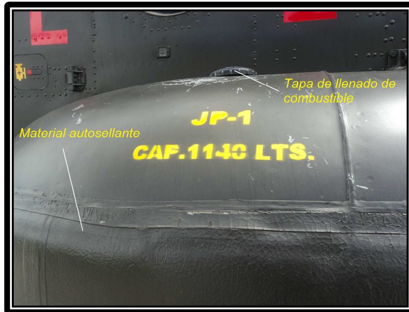
Figura 2. 11: Tanque de combustible externo material de auto sellamiento
