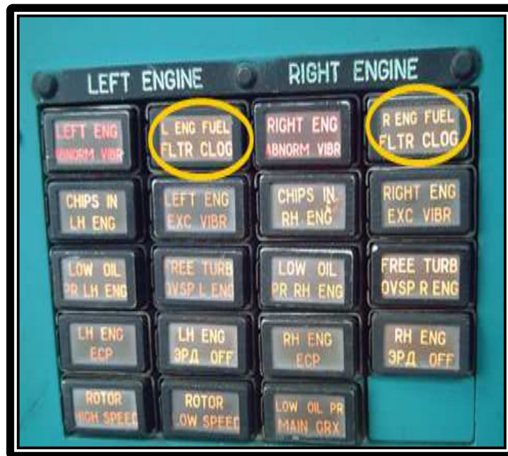
Figura 2. 48: Síntomas sobre el taponamiento del filtro de combustible
