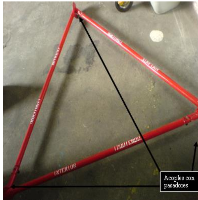
Fig. 2.1 Diseño de la segunda alternativa de un Triángulo de Izada de las alas de avión Mirage F-1 con acoples que utilizan pasadores con su respectivo seguro.
