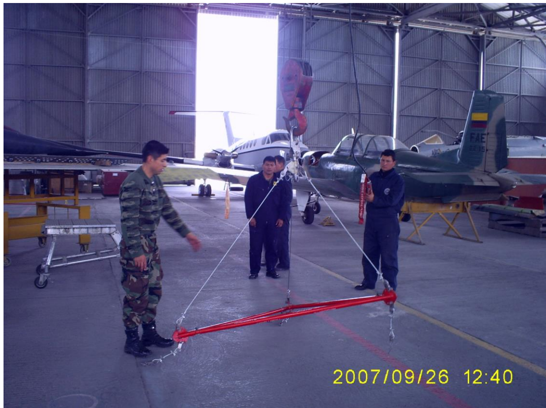
Fig. 4.6 En esta figura se muestra al personal de mantenimiento realizando la llamada presentación del conjunto de izamiento del ala del avión Mirage F-1
