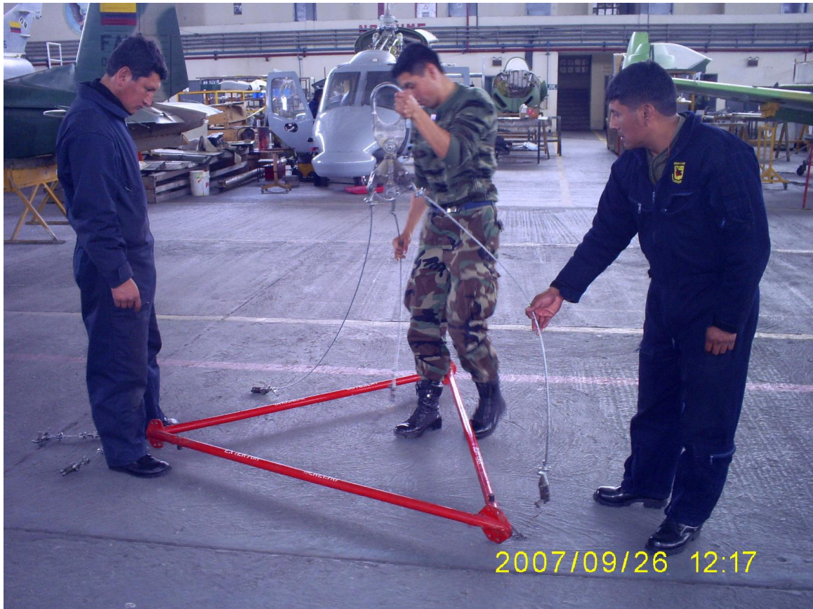
Fig. 4.2. En esta figura se muestra los cables de acero acoplados a la estructura del triángulo de izada de las alas del avión Mirage F-1.
