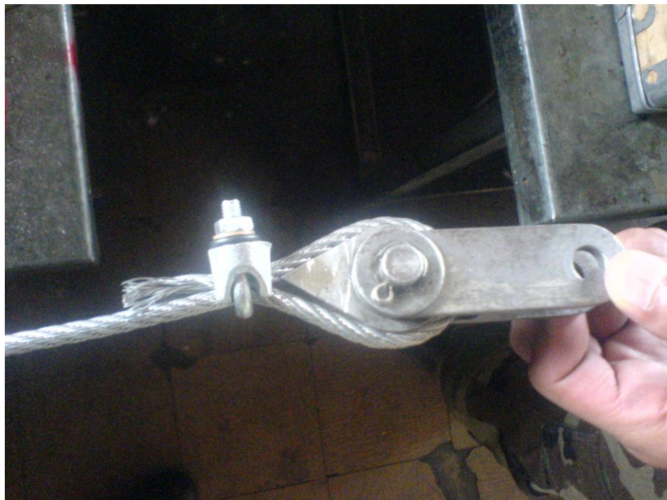
Fig. 3.9 Grafico en el cual se indica el cable unido a la polea sujetado por el grillete.
