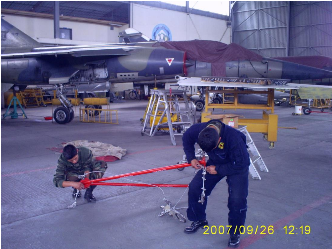
Fig. 4.4. En esta figura se muestra al personal de mantenimiento realizando el acoplamiento de los cables más pequeños a la estructura del triángulo, los mismos que posteriormente serán acoplados al ala del avión Mirage F-1.
