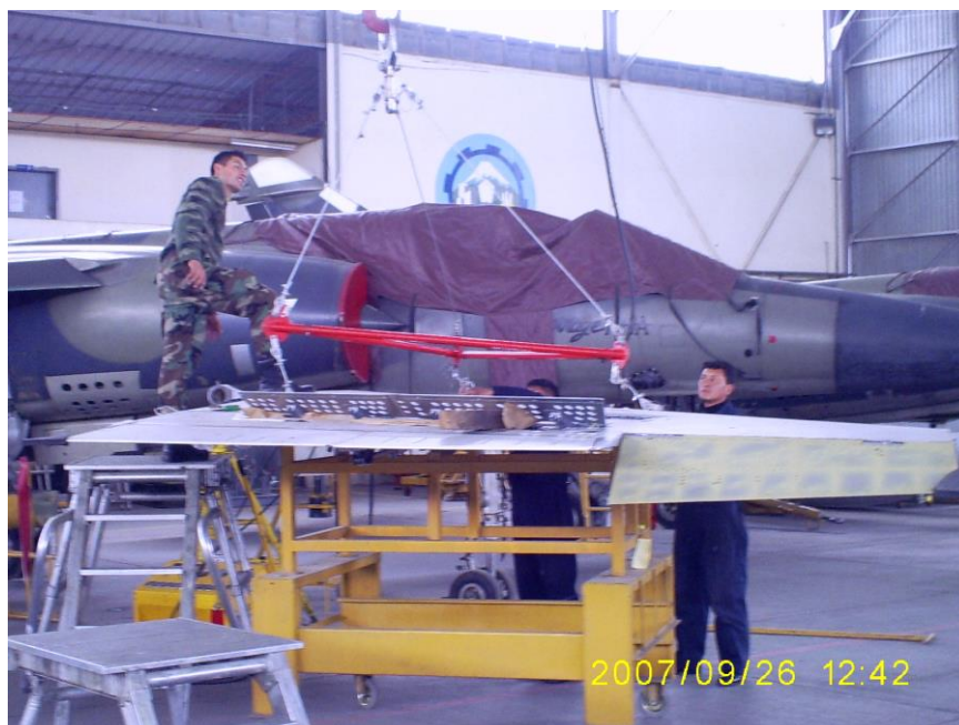
Fig. 4.9 En esta figura se muestra al personal de mantto. Colocando al triángulo de izada en una posición correcta para poder llevar a cabo el izamiento del ala del avión Mirage F-1.
