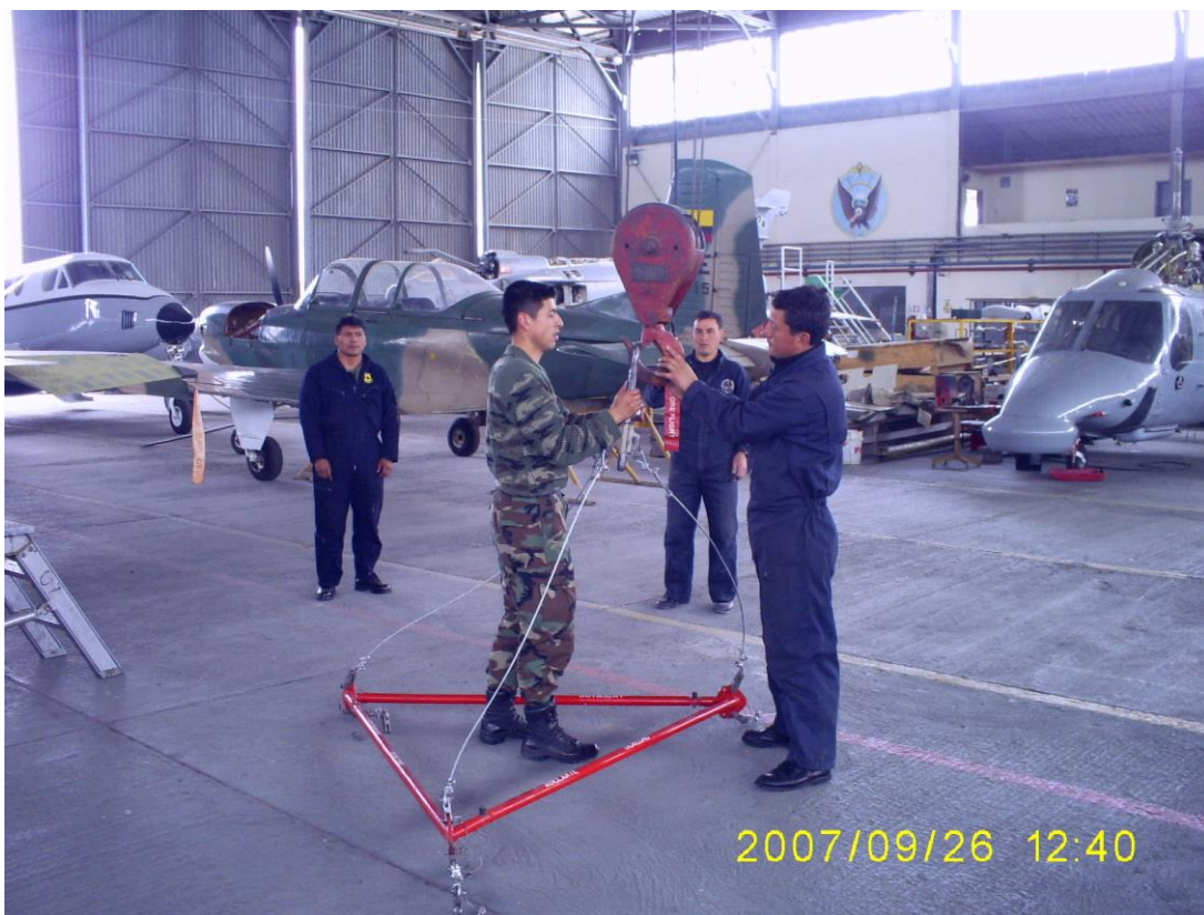
Fig. 4.5 En esta figura se muestra al personal de mantto. Realizando el acople de toda la estructura del triángulo de izada con su eslinga hacia al tecele.
