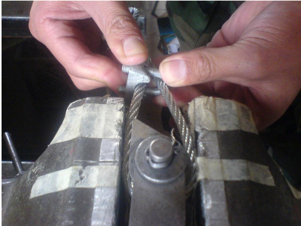
Fig. 3.8 Grafico en el cual se indica el momento de la colocación del grillete alrededor del cable para sujetarlos.
