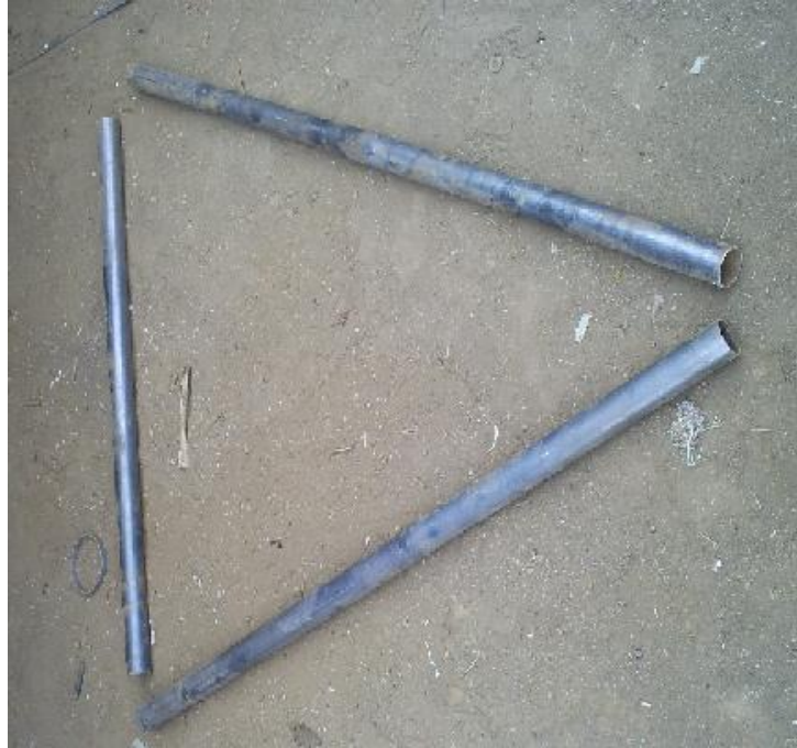
Fig. 3.3 Gráfico que muestra los tres tubos de acero cortados, los cuales van a ser la estructura del triángulo.
