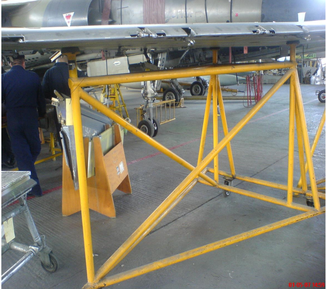
ANEXO L. (Ala montada en el mueble de apoyo respectivo después de haber sido desmontada del avión Mirage F-1)
