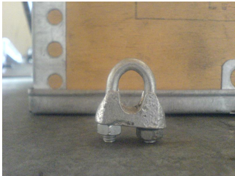
Fig. 3. 7 Gráfico representativo de una los grilletes que son utilizadas para sujetar los cables al momento de ser conectados a las poleas
