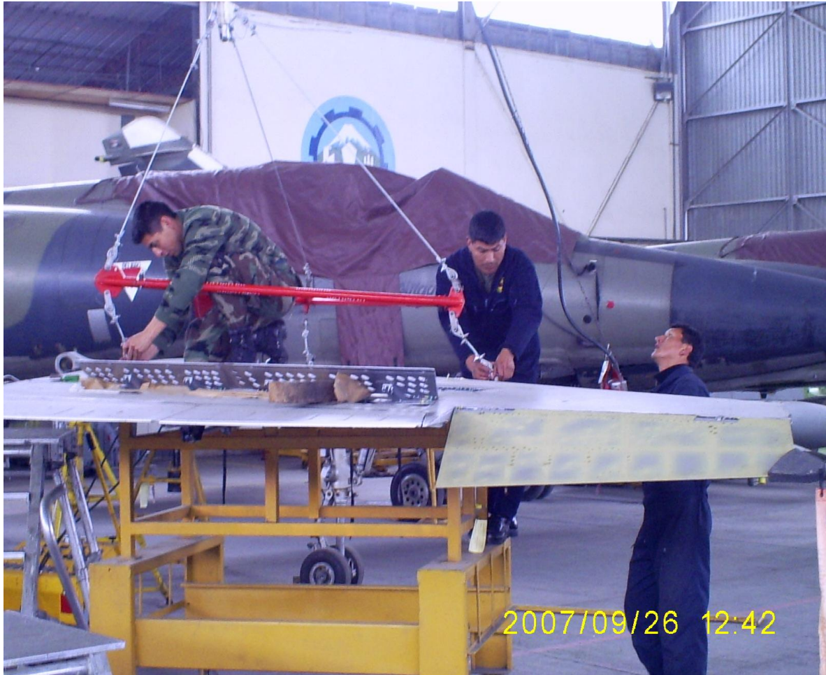
Fig. 4.8 En esta figura se muestra al personal de mantenimiento realizando el acoplamiento de los cables de acero en la estructura del ala del avión Mirage F-1.
