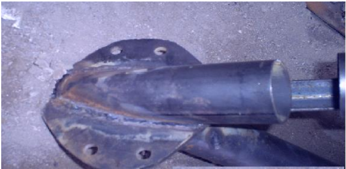
Fig. 3. 5 En los gráficos anteriores se indica una de las esquinas del tubo de acero soldada con la respectiva platina.
