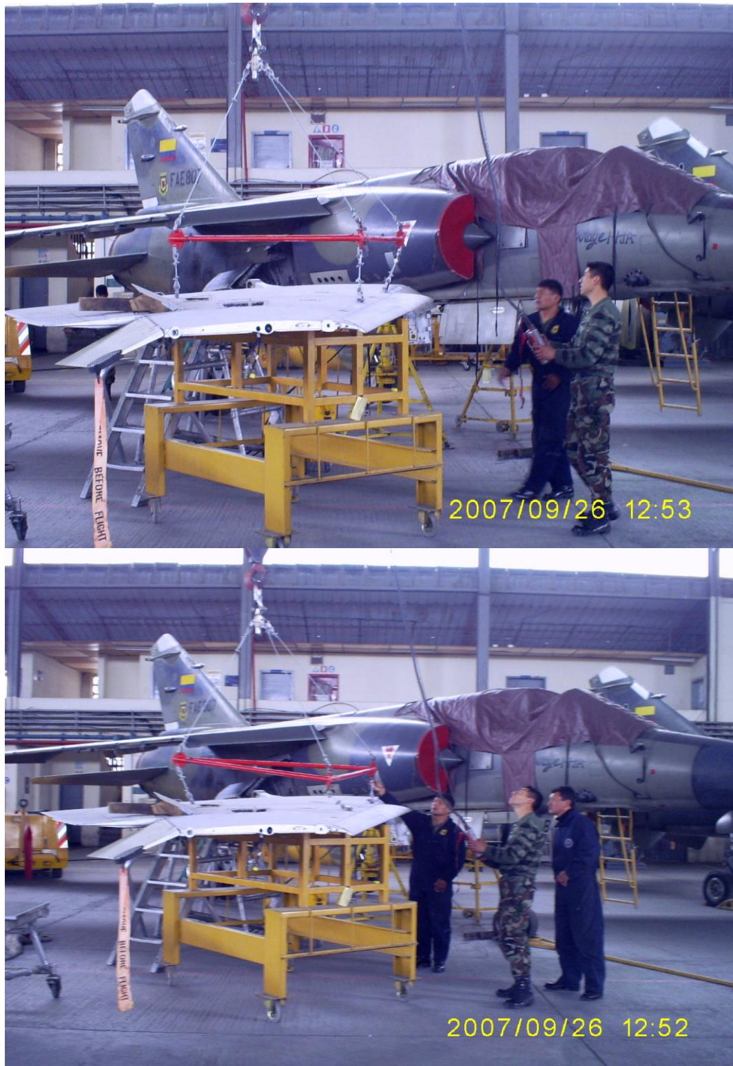
Fig. 4.10 En esta figura se muestra al personal de Mantenimiento realizando el izamiento del ala del avión Mirage F-1.
