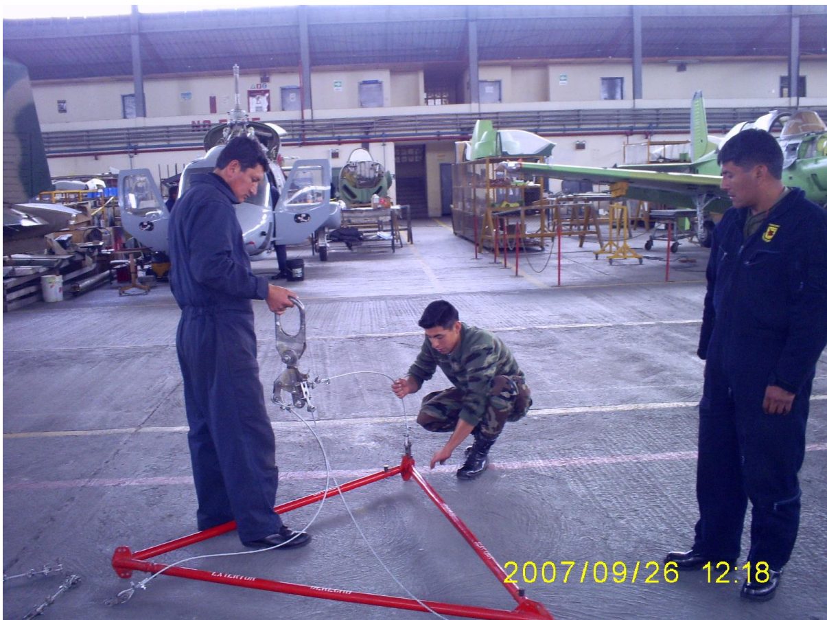
Fig. 4.3. En esta figura se indica al personal de mantenimiento conectando los pines de las poleas y verificando que las mismas se encuentre bien aseguradas.
