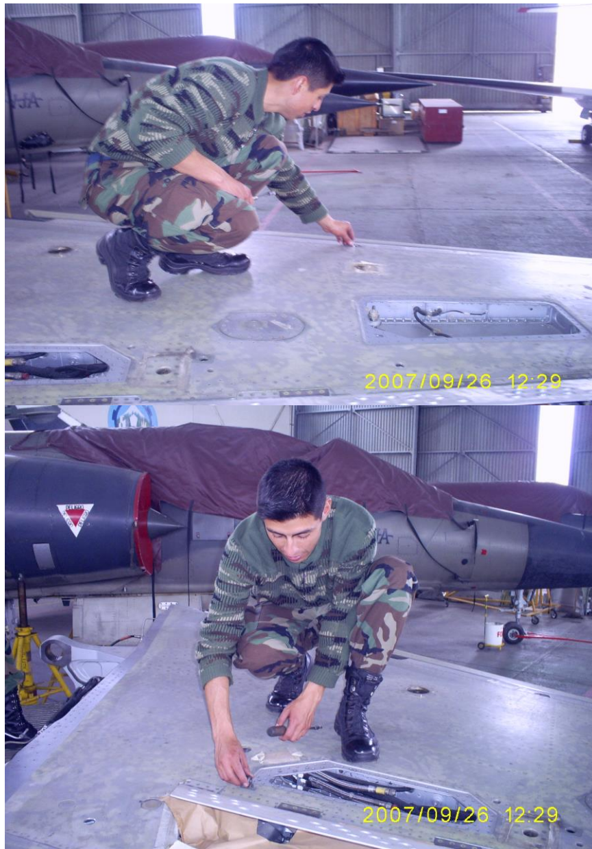
Fig. 4.7 Se muestra al técnico de mantenimiento realizando la colocación de unos pernos especiales que van acoplados a los cables del triángulo de izada de las alas del avión Mirage F-1.
