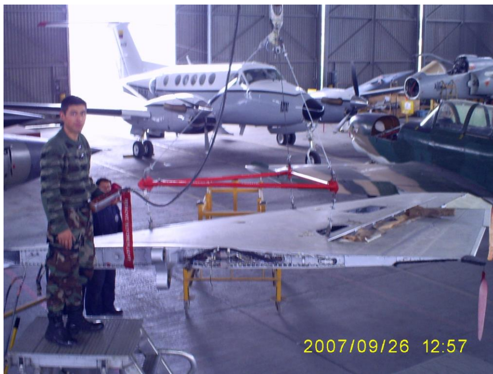
Fig. 4.11 En estas figuras se muestra al ala completamente izada y sostenida por la estructura de la eslinga y del triángulo que a su vez están sujetas al tecele.
