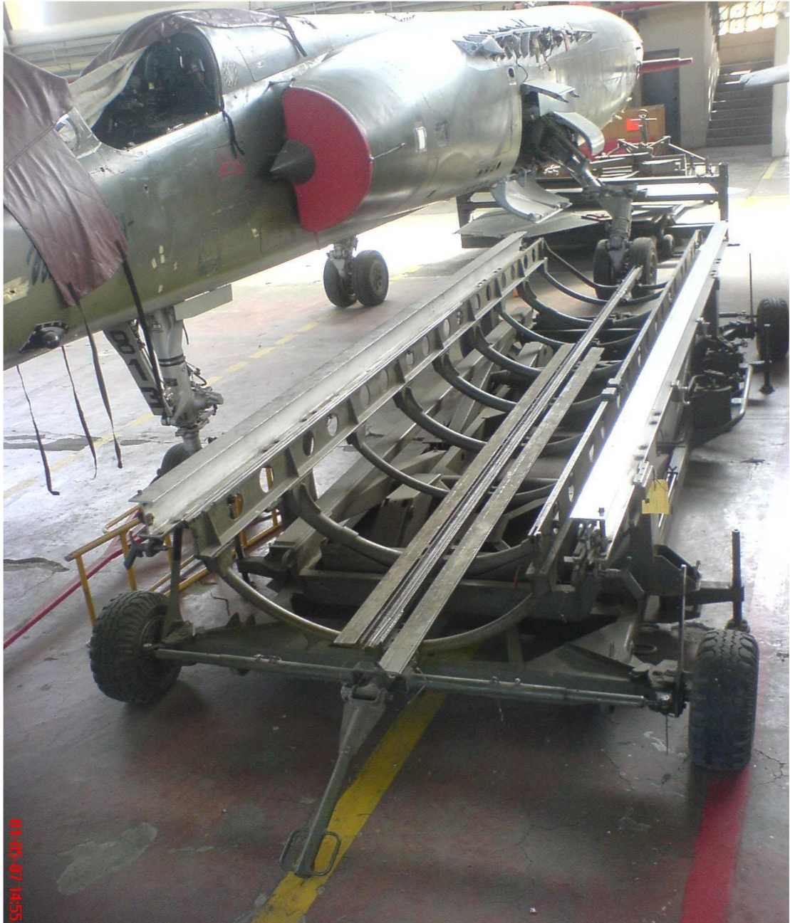
ANEXO G. (Chariot que se utiliza para montar el ala con su respectivo mueble antes de realizarse el montaje o desmontaje en el avión.)
