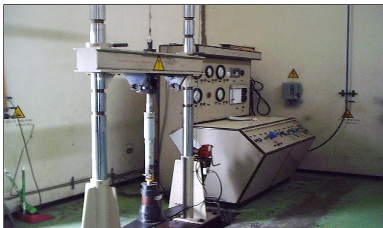
Fig. 3.2 Banco de prueba para el shock absorber 01-A de presión hidráulica.
