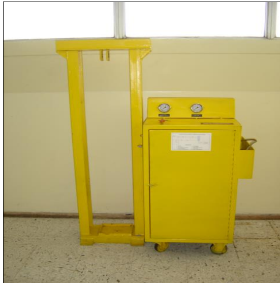
Fig. 3.1 Banco de prueba para el Shock absorber del avión Arava
