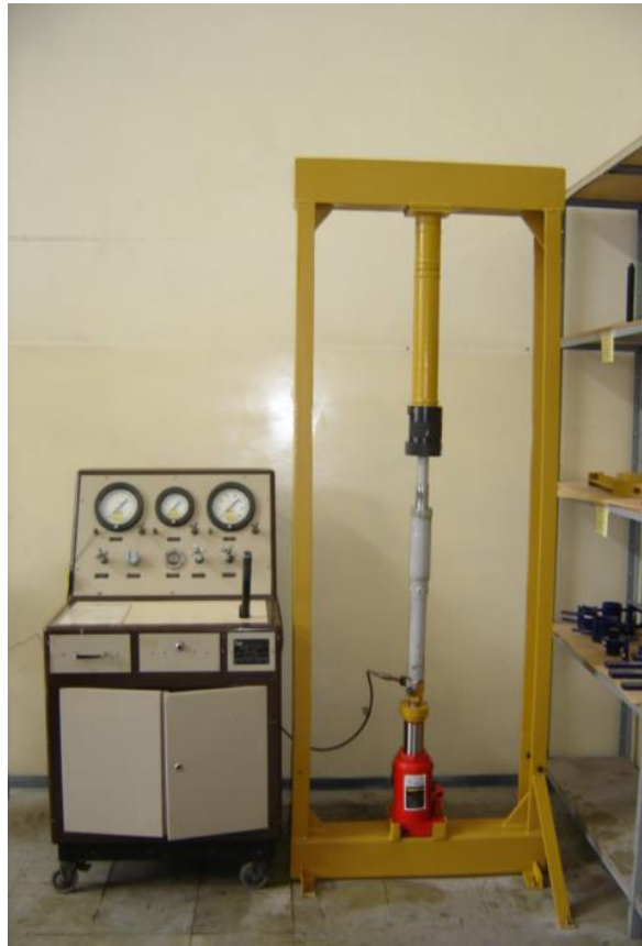
Fig. 3.3 Banco de prueba para el llenado y pruebas para el chequeo de los diferentes trenes de aterrizaje de las aeronaves
