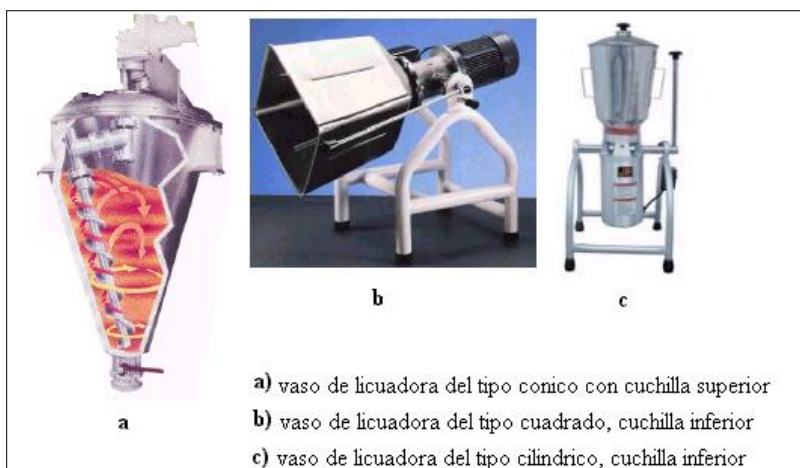
Figura 2.6. Tipos de vasos verticales por su geometría de alojamiento.
