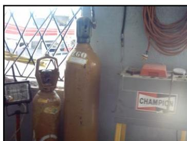
**Figura 1. 53 Limpiador de Bujías, Tanques de Nitrógeno y Lámpara Portátil.**
