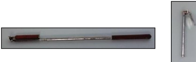
**Figura 1. 33 Lente Óptico e Imán con Extensión.**
