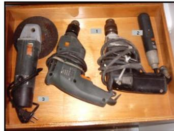
**Figura 1. 39 Taladro, Desarmador Eléctrico y Pulidora.**
