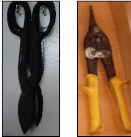
**Figura 1.18 Tijeras para láminas de estructuras.**
